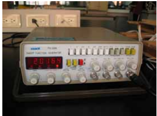
彩圖四、設置訊號產生器
