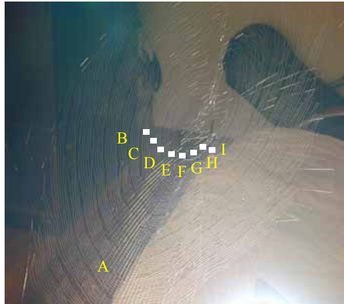
圖十四、人面蜘蛛( N. pilipes )蛛網不同放射絲縱波傳遞測試之觀測點配置圖。
