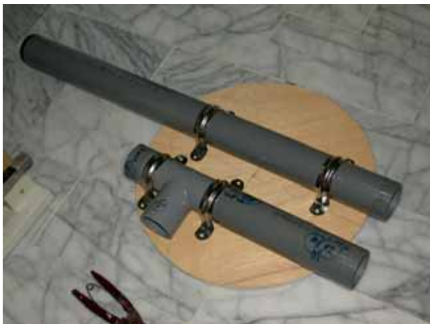
照片 33 雙導光管設計初步，估計和嘗試排列設置
