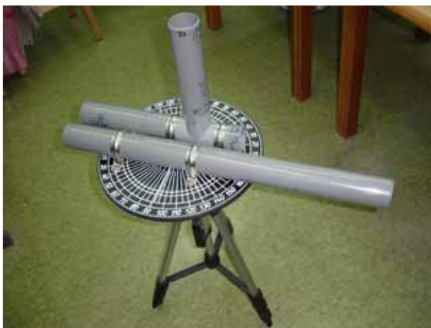
照片 35 導光管與方向刻度盤及專用架固定妥當
