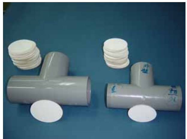
照片 32 橢圓形壓克力分光鏡能以 45 度角與 T 形連接管密合
