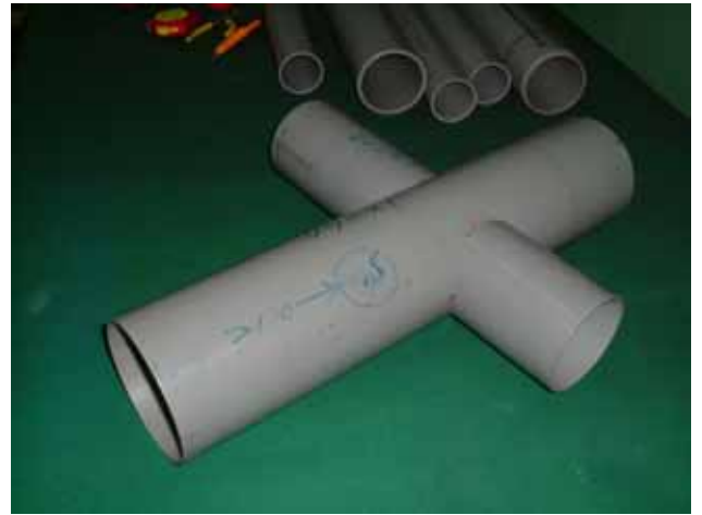
照片 14 十字型導光管密接完成
