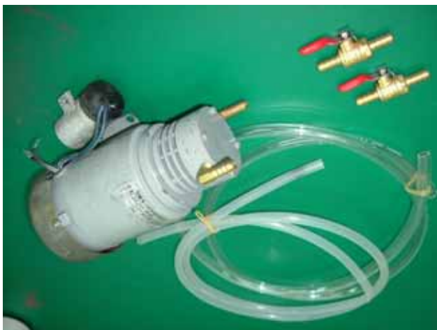
照片 17 舊貨攤買到的循環吸放式抽氣機
