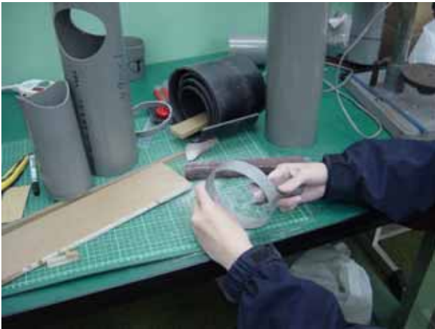
照片 13 固定透鏡之墊圈須磨至與透鏡恰能密合
