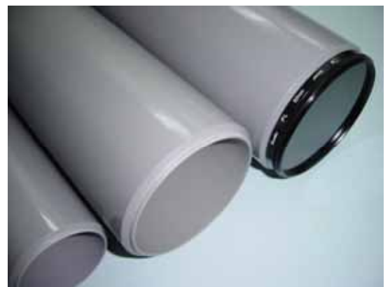
照片 42 在導光管口攻牙以順利旋轉調校偏光鏡角度
