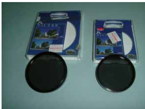
照片 41 線性偏光鏡能濾除複散射光(multiple scattering)
