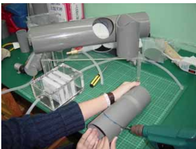
照片 19 導光管的進氣和出氣孔須與濾氣器相接合
