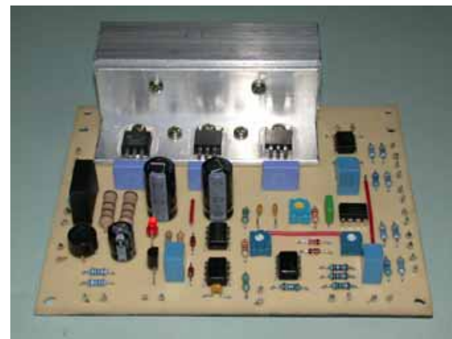
照片 50 散熱片及 PC 板零件全部焊妥完成
