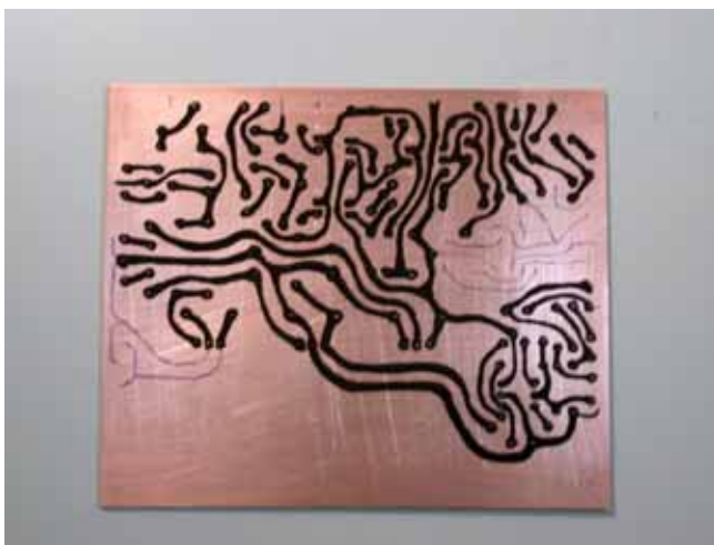
照片 47 依方格紙設計圖以油性筆繪出零件連線圖案
