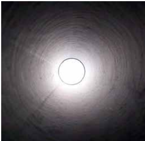
照片 37 導光管雖經塗黑處理朝向強光時漫射仍強
