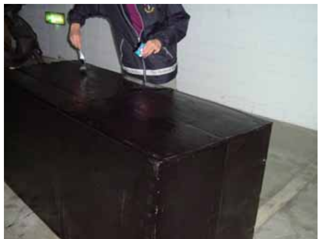
照片 36 兩個長 2.2 米寬 1.3 米的暗箱內外皆塗黑並黏以黑色布料
