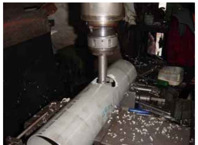
照片 10 十字形導光管中央相接合處要密接處理
