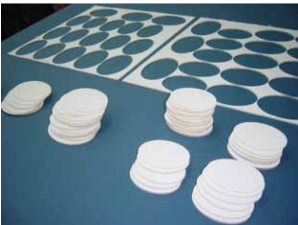
照片 31 一般玻璃無法用雷射切割，改用透明壓克力分光鏡
