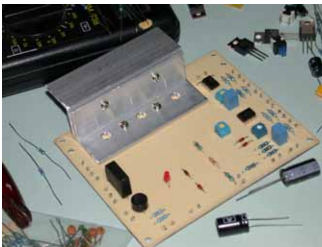
照片 49 PC 鑽孔後開始小心焊接零件
