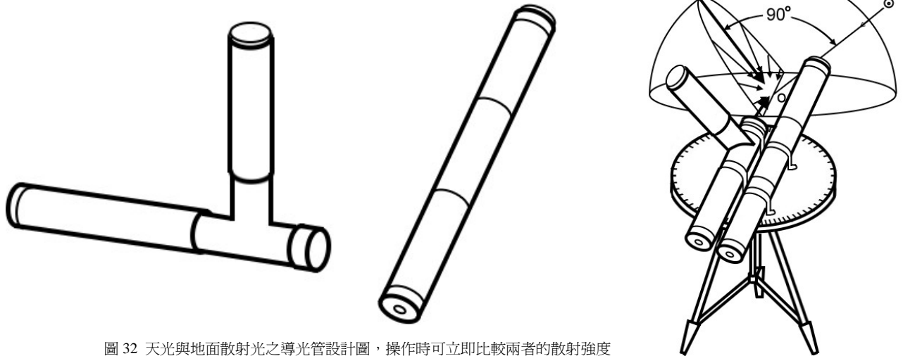
圖 32 天光與地面散射光之導光管設計圖，操作時可立即比較兩者的散射強度
