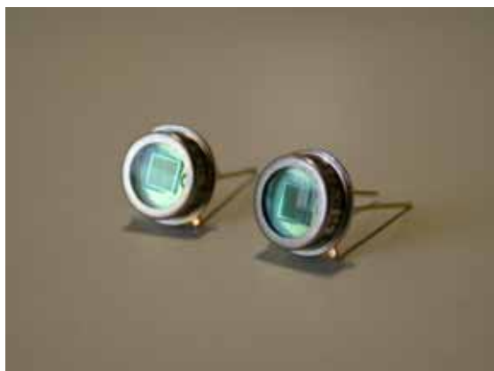
照片 43 使用極高零敏度、高線性度的光感測元件
