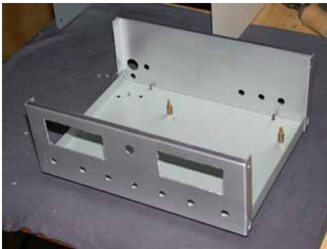
照片 53 機殼面板及背板鑽孔處理完成，與底盤組成一體
