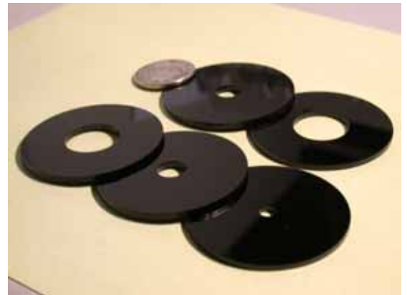
照片 40 環狀光欄之孔徑依導光管幾何長度次第減小
