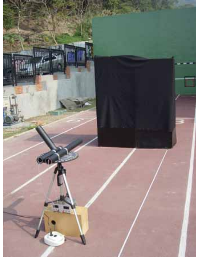
照片 60 導光管與暗箱相距約 21cm 地面散射光已有讀數，非常靈敏
