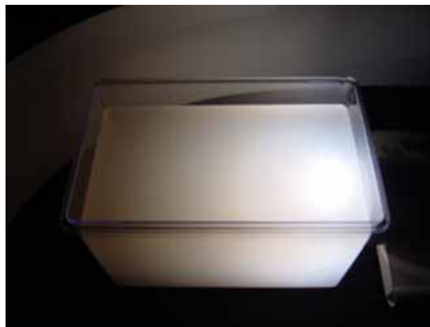
照片 4 右端藍光散射極強，左端藍光散盡餘較多紅光
