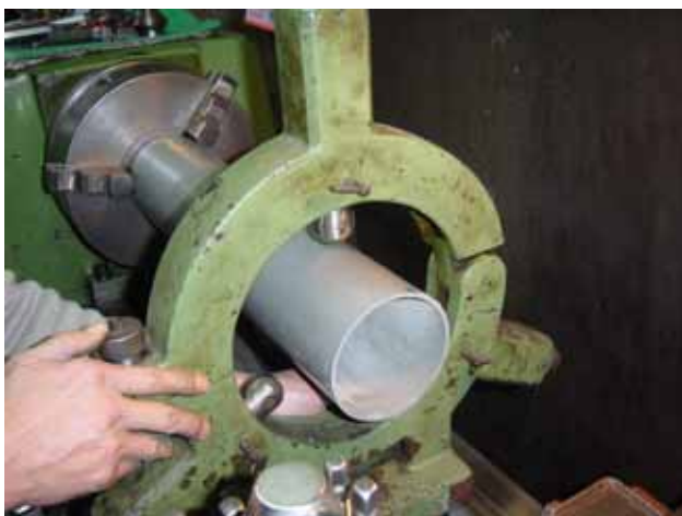
照片 9 導光管頂須攻牙以便旋轉透鏡調整上下位置
