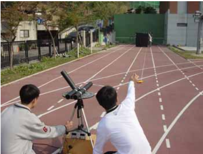
照片 61 實驗暗箱與導光管間距離 60 米時天光讀數仍大於地面散射光
