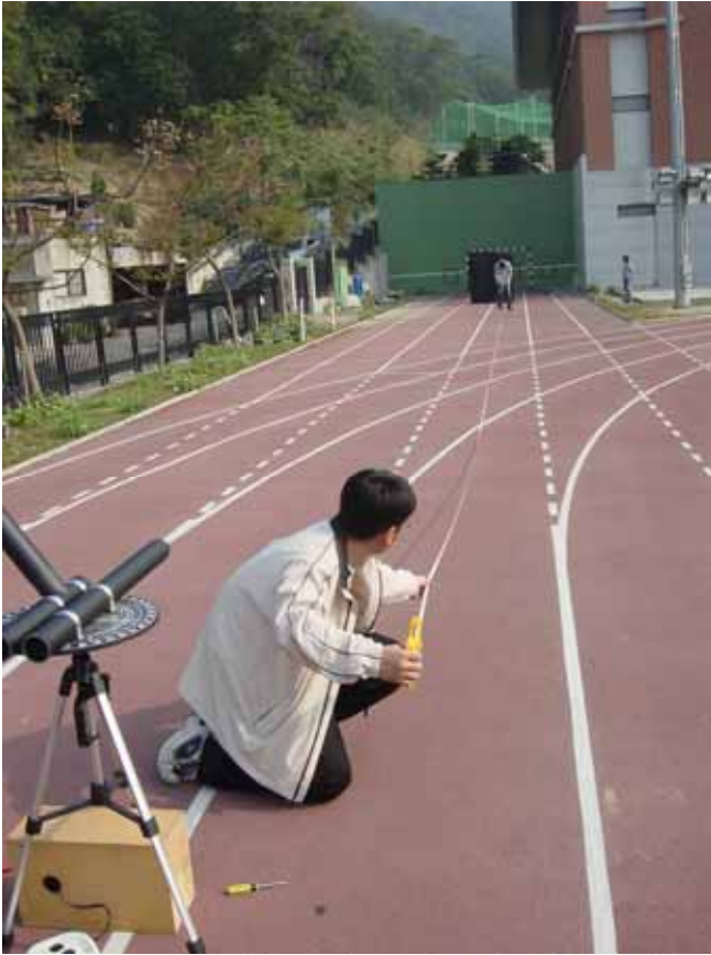
照片 59 實驗暗箱與導光管間距離以滾筒式皮尺精確測量
