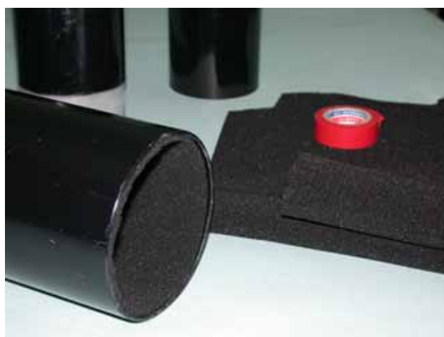
照片 20 導光管內外塗黑並黏貼黑色毛毯去除反射
