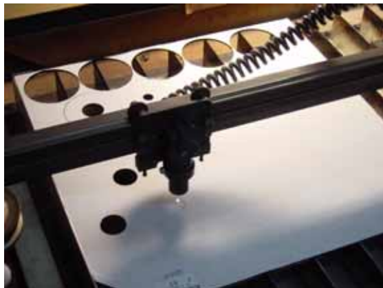
照片 39 用雷射刀精準切出環狀光欄以阻止管壁反射
