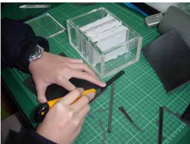
照片 15 用活性炭及脫脂棉製作空氣過濾網
