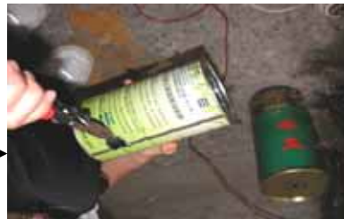
大、小茶葉罐底釘打剪出燈座線的孔及光柵透氣柱
