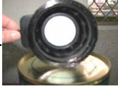
光度計準備倒蓋於承載二滴溶液的投影片上
