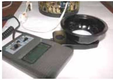
光度計套上剪切好的塗黑果凍杯上
