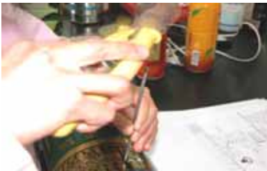
小茶葉罐頂釘打並剪出比凸透鏡略小的洞來
