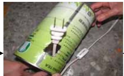
將燈泡座的插頭穿過小茶葉罐底所自己釘打的洞
