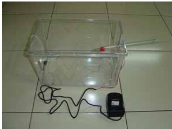
圖二十三 簡易質量電鍍器之側面圖
