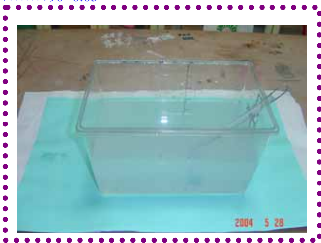
圖十九 鍍銀過程 鍍銀使用硝酸銀水溶液 \text{AgNO}_3 ，呈混濁。
