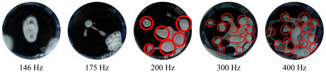
圖 8、共振皂水，因頻率不斷提高，而分離成數個共振皂水
