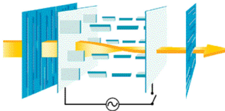
圖三 液晶分子改變光的偏振方向示意圖
