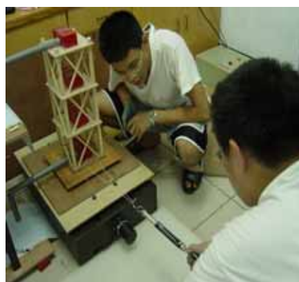
用彈簧秤測量阻尼材料勁度
