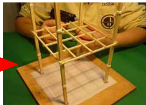
(七)在底板上插入 4 枝柱子，再套入樓板，於樓板黏合處，將柱與樓板黏合，三層樓板依次黏好。
