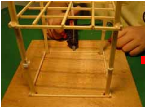
(十)將地樑與木板黏合，並將4洞灌滿熱熔膠固定。
