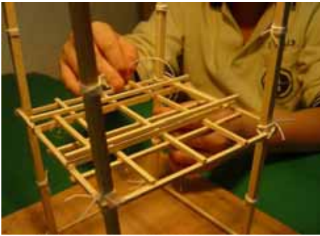
(十二)用棉繩將每一樑與柱以繞二圈方式綁緊。
