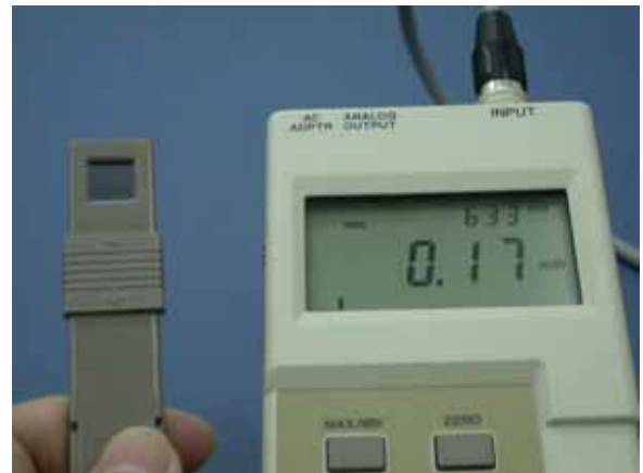
TQ-8210 配備一具平面型之光探測頭,受光面積為 1cm^2
