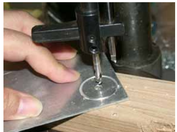
在鋁板切割 PD 的固定框，也兼具 PD 的散熱功用
