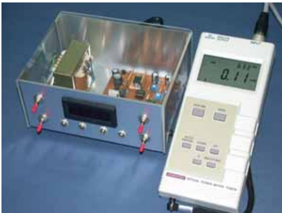
以僑借的 ADVANTEST TQ8210 校正自製的光照度計
