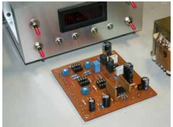
PC 板焊妥，待置入機箱後自製的照度計即將完成
