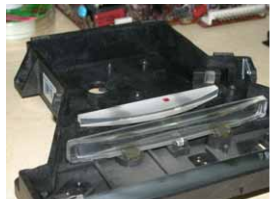
每一款雷射印表機內都有不同型式的 f\theta 透鏡組合
