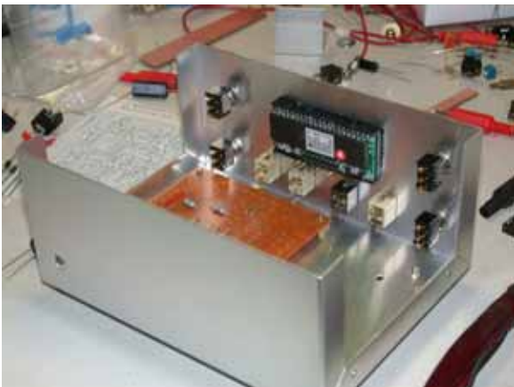
須先完成機殼外圍的開關、插頭及顯示器部分再做內部
