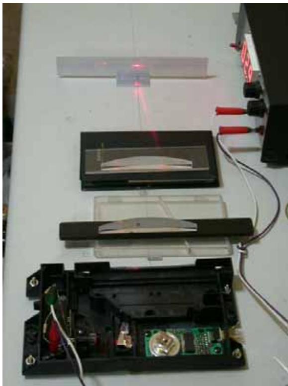
f\theta 透鏡焦距測量及線性掃描範圍的實驗過程
