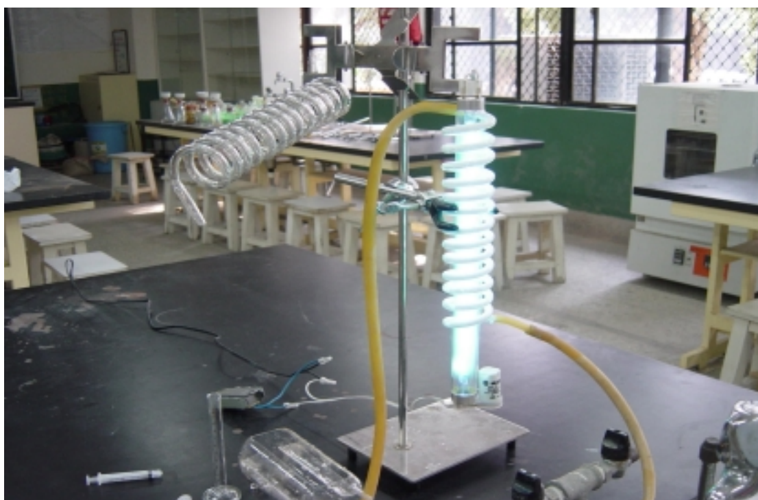
圖十四 照射紫外光中之鍍 \text{TiO}_2 螺旋管行紫外光降解實驗
