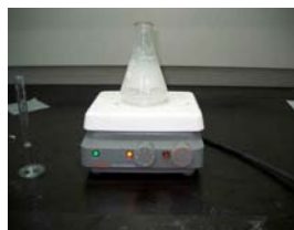
圖 1：四氯化鈦/乙醇/水的溶液加入氨水
