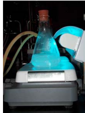
圖 8：0.3 克奈米二氧化鈦溶於 0.1M KOH 水溶液，以 1.5 瓦紫外光照射進行光催化反應
