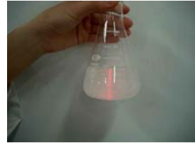
圖 8：0.3 克奈米二氧化鈦溶於 0.1M KOH 水溶液以紅色雷射筆照射，產生光散射現象
