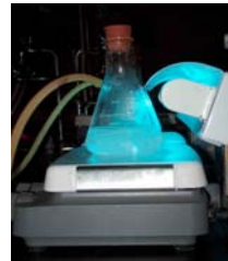
圖 9：0.3 克奈米二氧化鈦溶於 0.1M KOH 水溶液，以 1.5 瓦紫外光照射進行光催化反應
