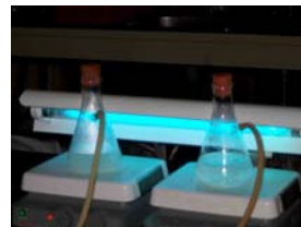
圖 10：0.3 克奈米二氧化鈦溶於 0.1M KOH 水溶液，以 1.5 瓦紫外光照射進行光催化反應
