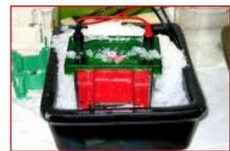
蛋白質電泳槽
