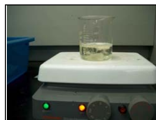
苯胺、過硫酸胺及混合型界面活性劑溶液，苯胺完全溶解
