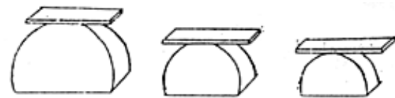
相同質量、相同長度之平板體在不同圓弧曲率半徑之搖擺
