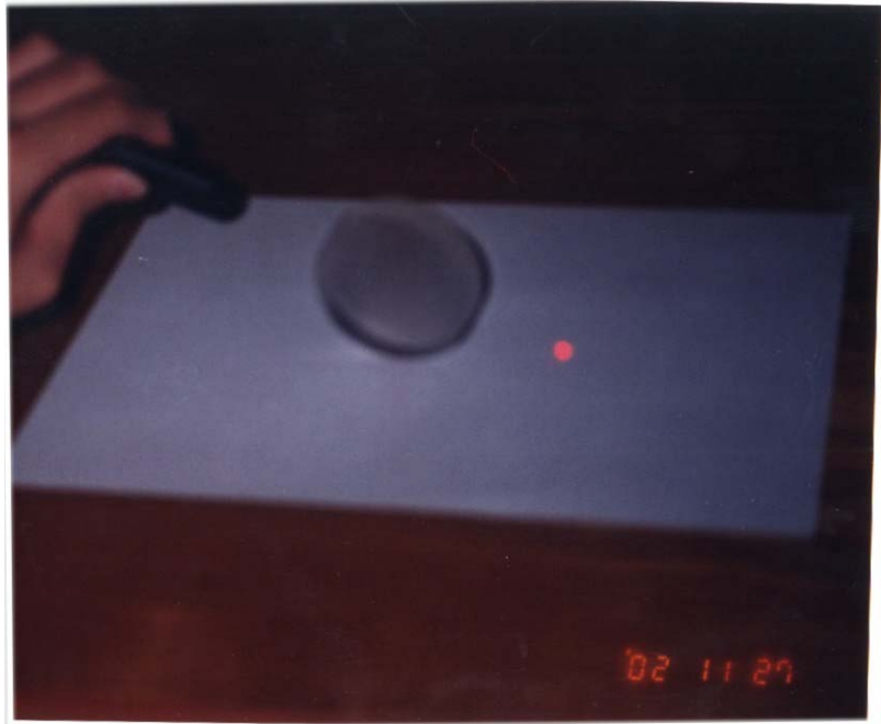
雷射光穿過圓形透鏡的成像
