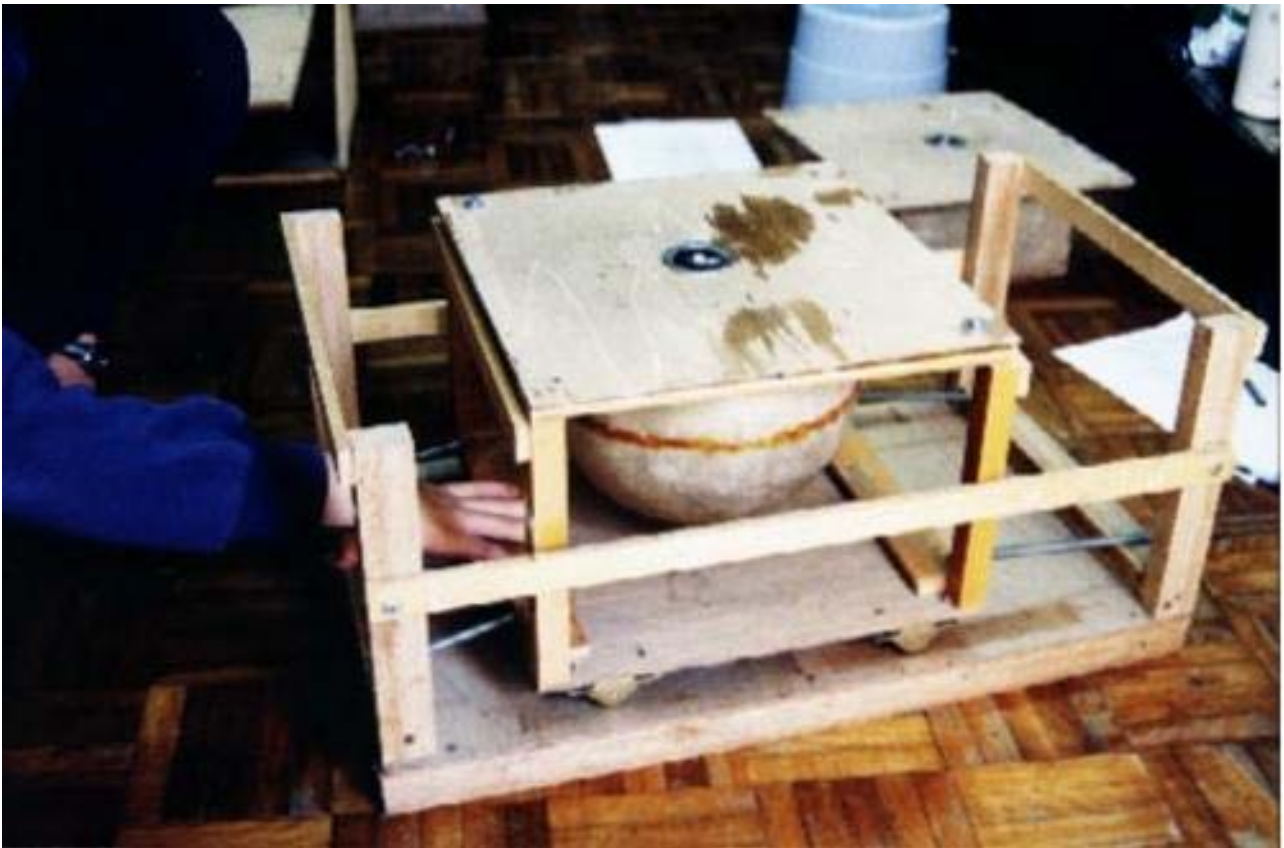
照片九、球形地基進行水平擺動模型
