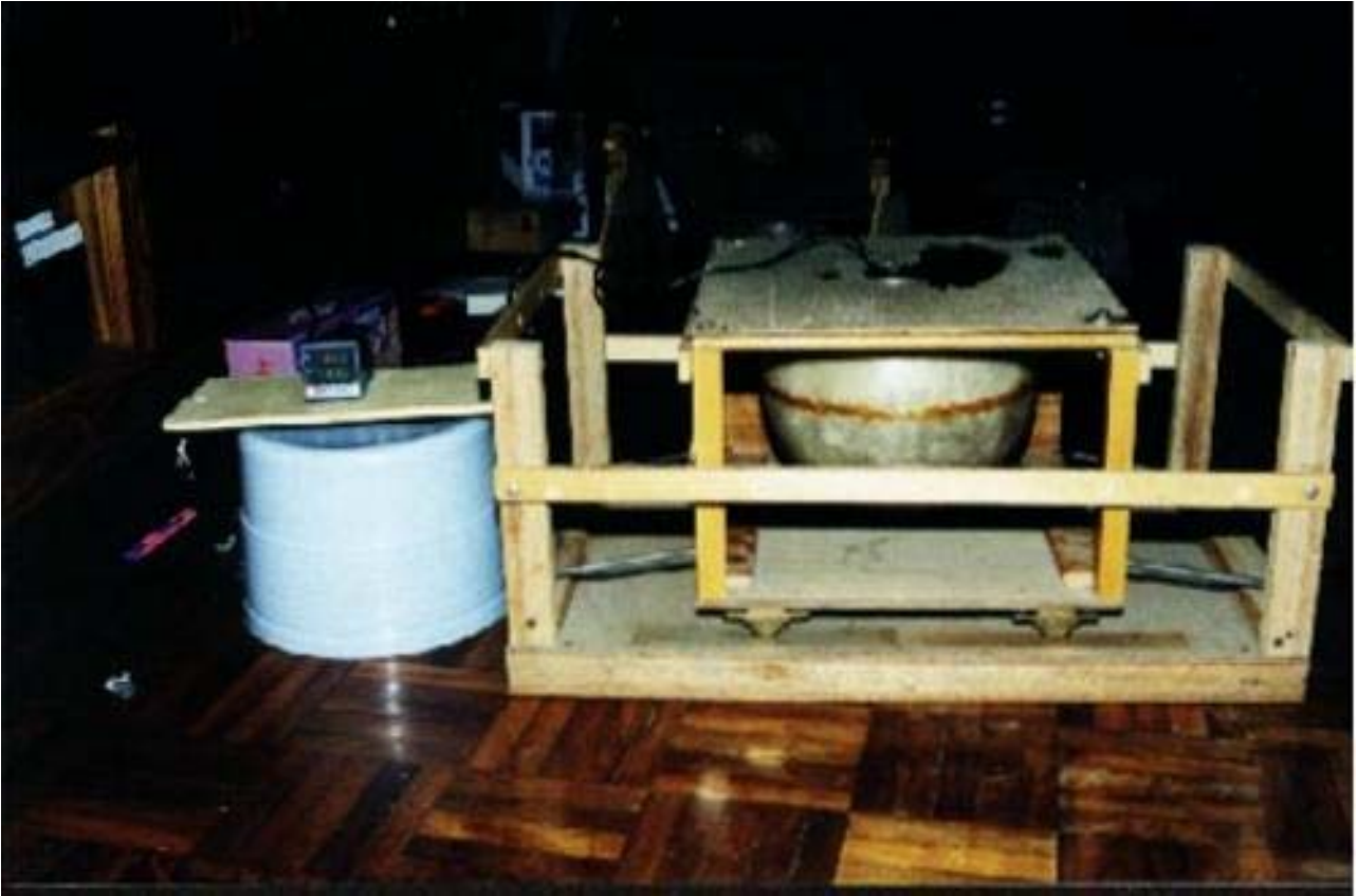
照片十二、平移擺動水溫的測量
