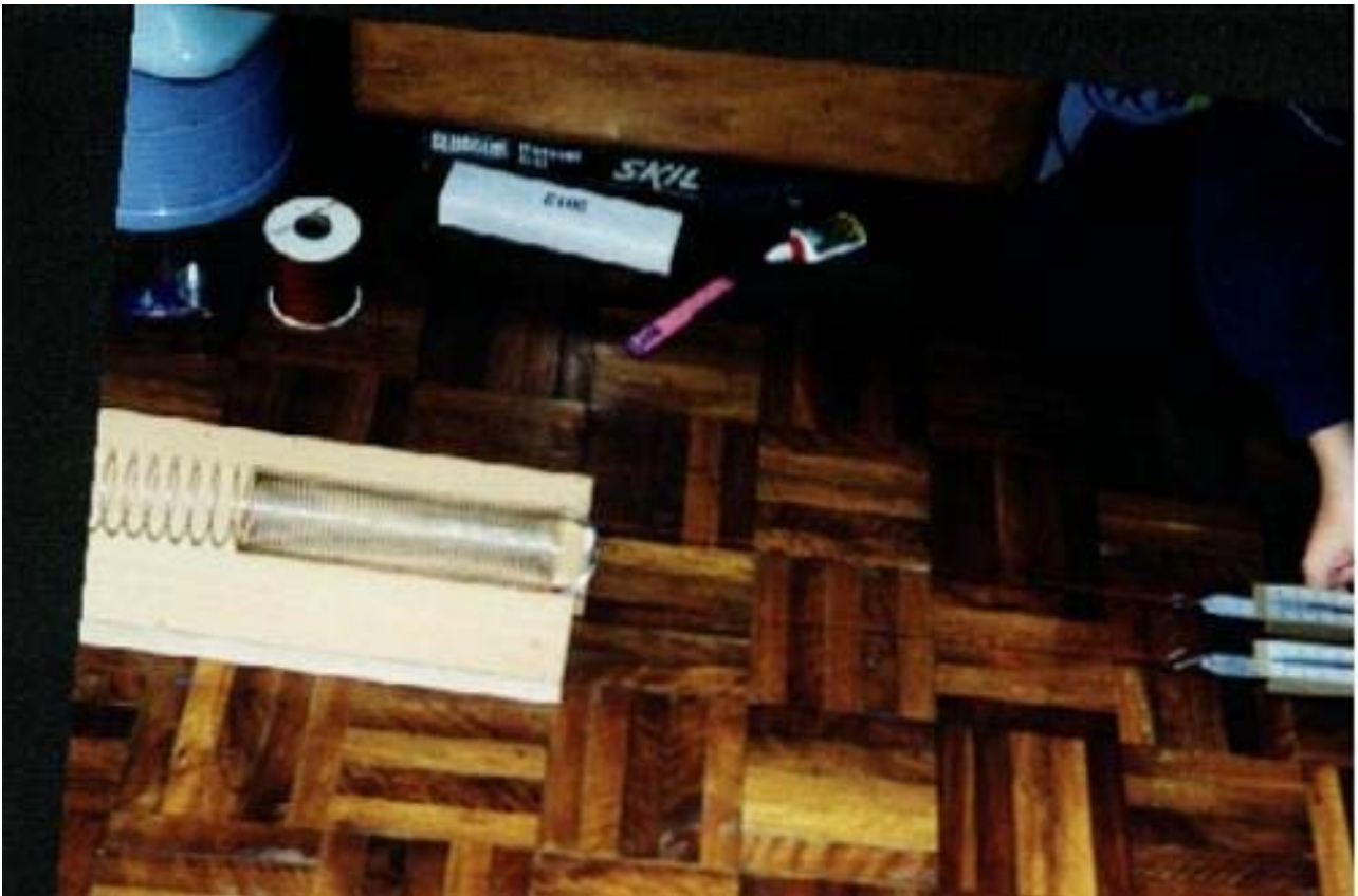
照片二、利用彈簧秤的拉力壓縮扁彈簧
