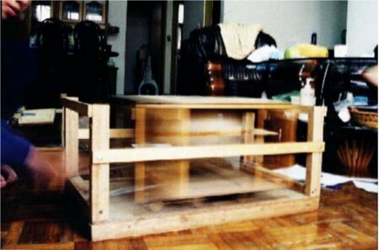
照片十一、平移擺動情形
