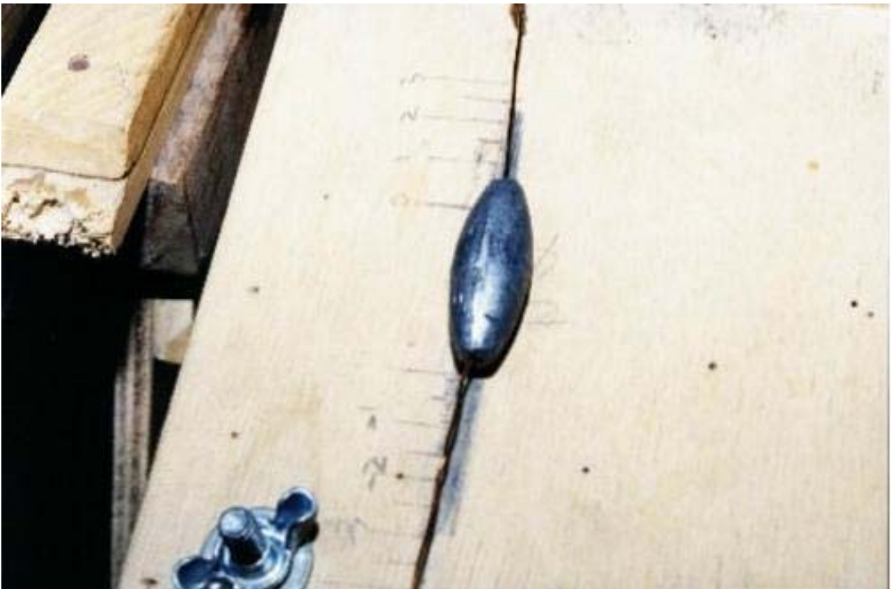
照片十四、鉛錘移動的對照刻度
