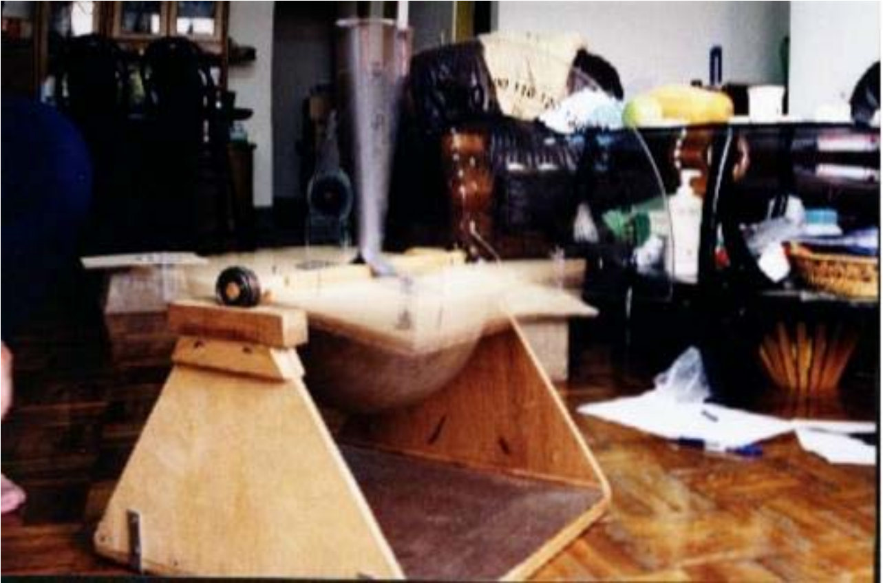
照片八、球形台地基擺動情形
