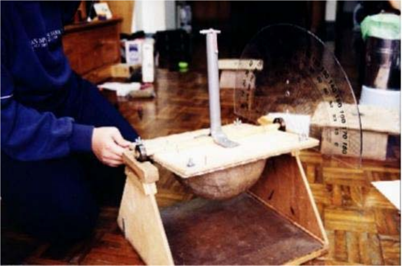
照片七、球行台地基擺動裝置
