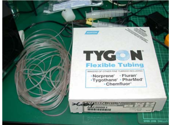
TYGON 管耐酸鹼也耐高溫及張力，透明度高又容易加工
