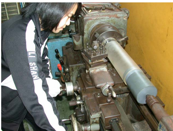
將空心圓柱亞克力定位好，再調整車刀的傾斜角度
