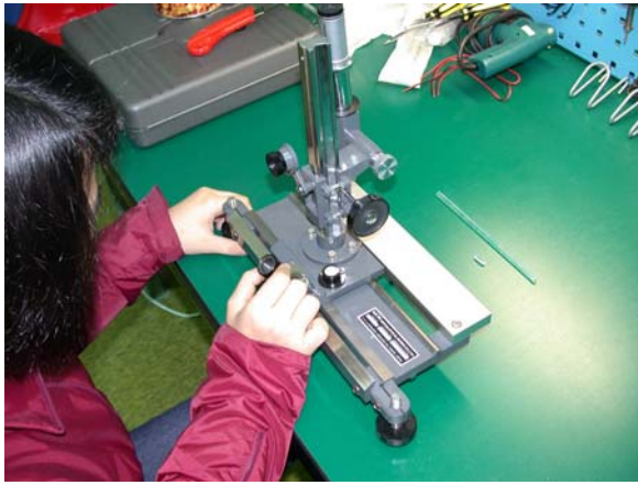
向老師借得走讀顯微鏡一台，可以測至 10^{-3} mm
