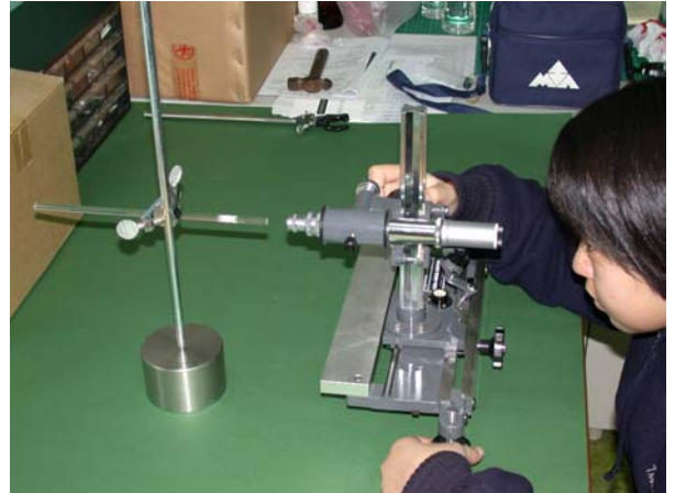
毛細管內徑是否準確，影響結果很大，須極小心測量
