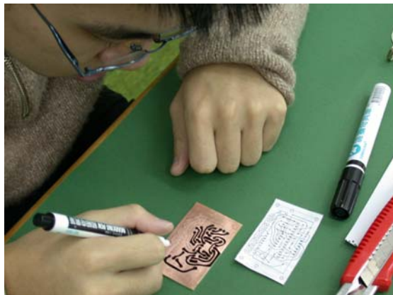
依原設計圖用奇異筆在 PC 板上畫電路走線圖
