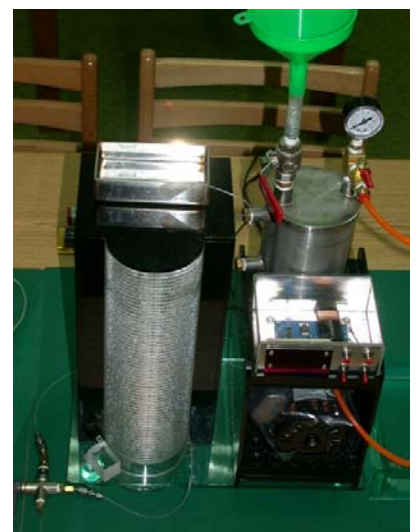
用電動幫浦壓縮式灌入液體至毛細管
