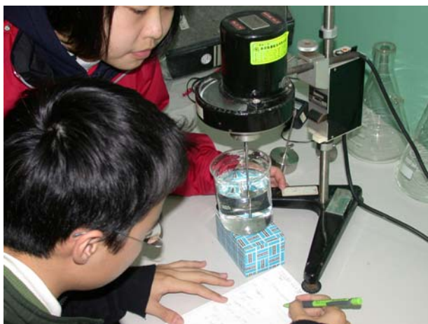
借得的馬達驅動黏度計測量黏度，好與我們的數據比對
