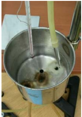
滴管應沿杯緣以免液面波動
