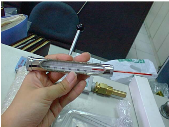
氣壓計或溫度計的毛細管內徑還不夠勻稱
