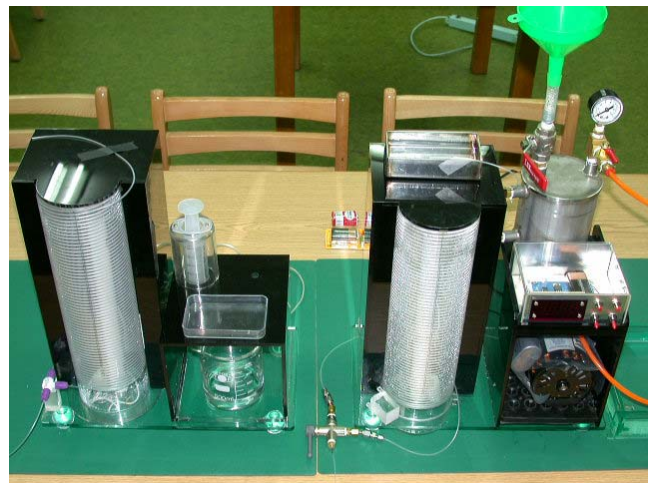
手動式或電動式幫浦都改成壓氣灌水 可避免產生氣泡
