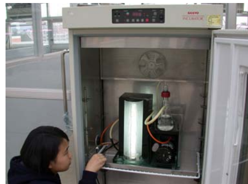
將整組旋轉毛細管黏度計安置於恆溫箱內
