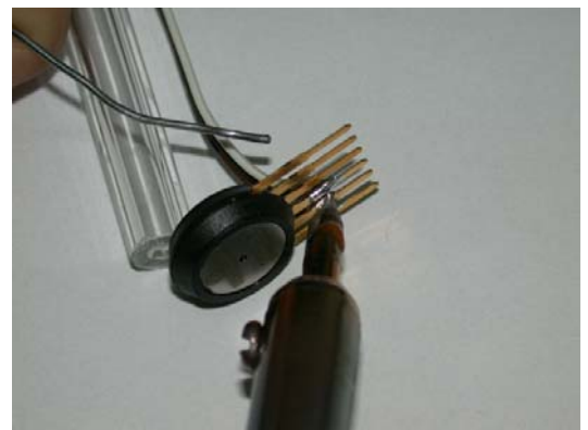
晶片接腳用彩虹線焊妥晶片上方小孔對正圓柱
