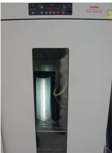
黏度計中央日光燈使流速觀測清晰
