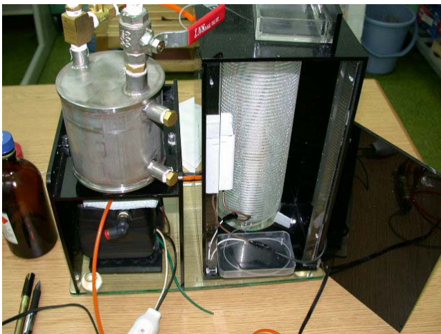
將三通開關移至毛細管底端出口，吸氣抽水改成壓氣灌水
