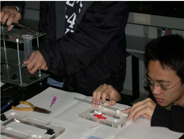
塑膠製的固定夾可以微調毛細管的高度
