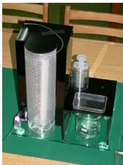
用針筒手動壓縮式灌入液體至毛細管
