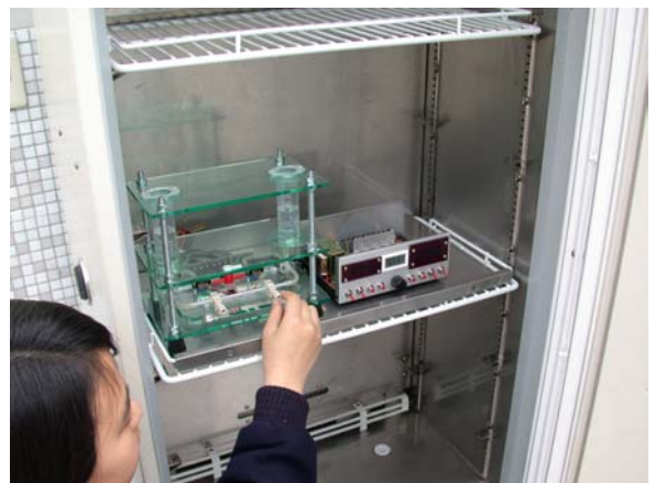
整組儀器移入恆溫箱中實驗，可自由設定環境溫度
