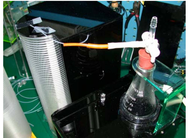
測高黏度液體如甘油時，牙軌間距選用 12mm 的較為恰當
