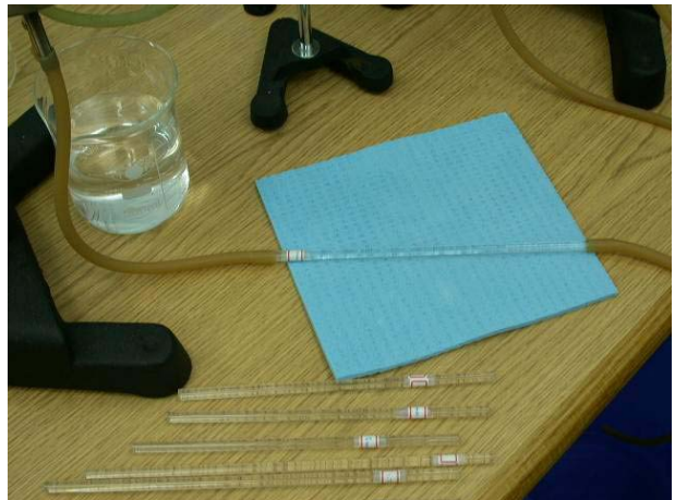
準備不同長度和不同口徑的毛細管待測
