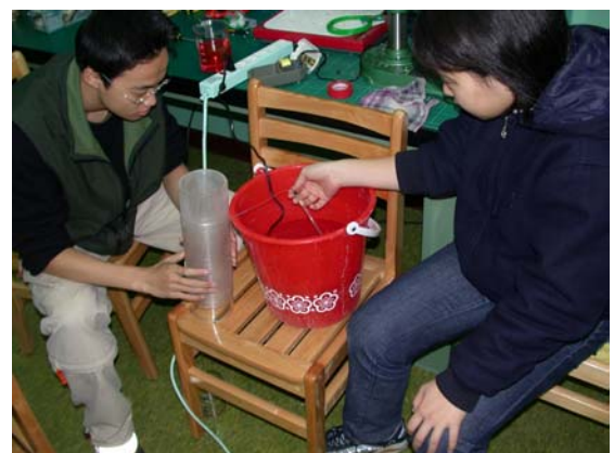
抽氣力量過大的 連三通止流閥都脫位漏水了
