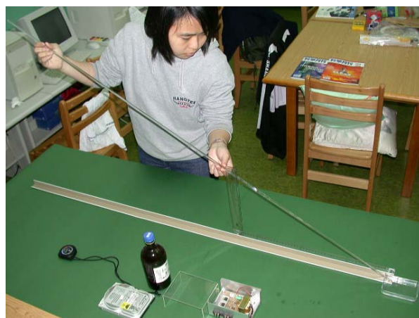
毛細管傾斜度降低流速果然變慢，可以準確測量流速
