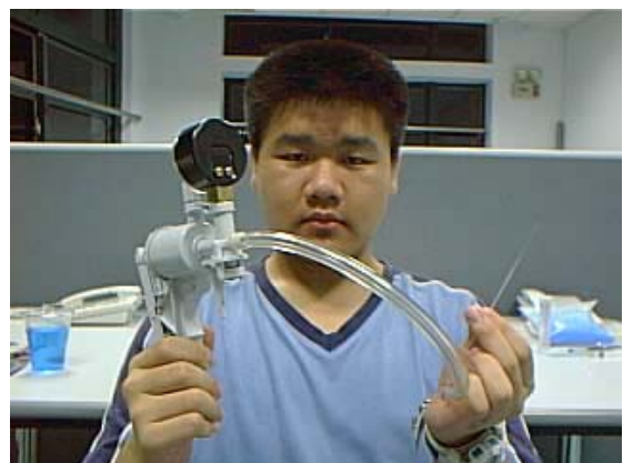
毛細管太長用嘴吸不動了 找出手動式吸氣器才夠力
