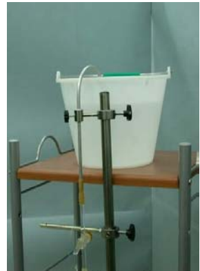
供水槽及虹吸管
