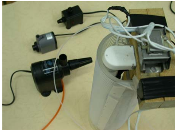
圓柱內置入日光燈，投射出強光可清楚觀察液柱流動
