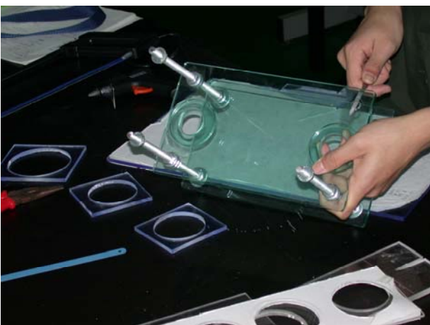
製作黏度計的三層支座之主體結構
