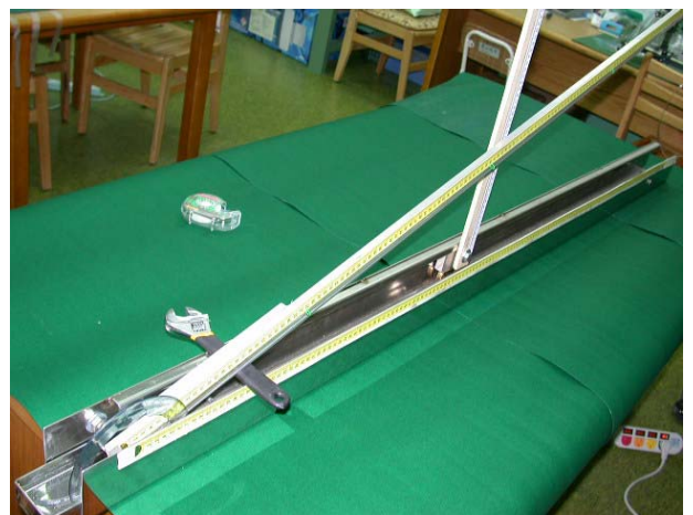
整個機台基座長度將近2公尺 佔滿實驗桌全長
