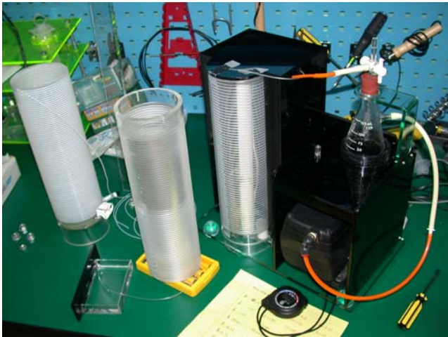
底座完成了，牙軌間距選用 5mm 的測低黏度液體很合適
