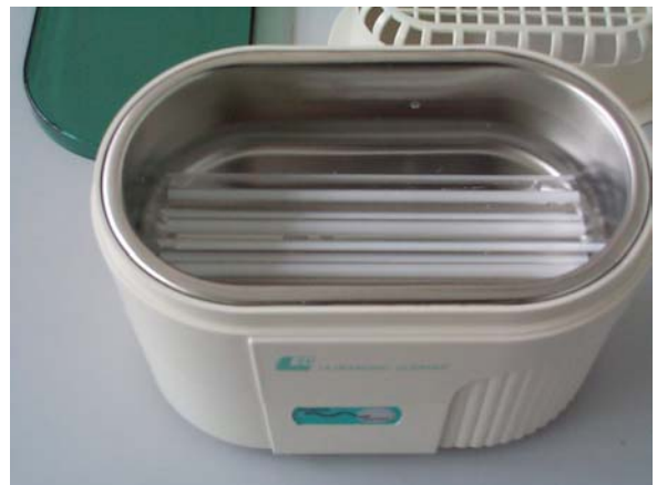
沸水中取出的毛細管投入超音波洗淨機中清洗
