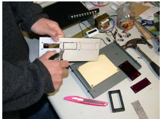
機殼面板用斜口鉗及銼刀處理矩形方孔
