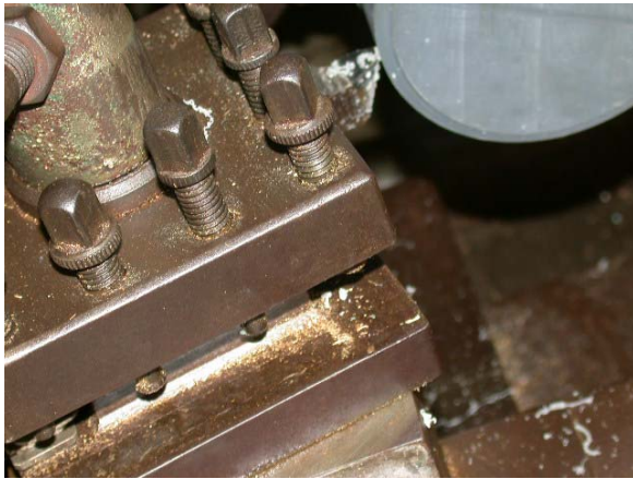
右上角圓柱邊緣的車刀已沾滿了切割牙軌碎屑
