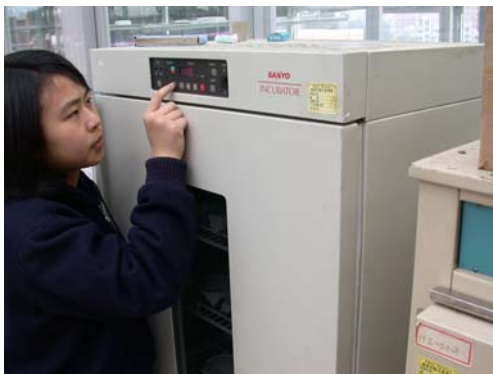
溫度可微電腦控制，正設定恆溫箱的溫度中
