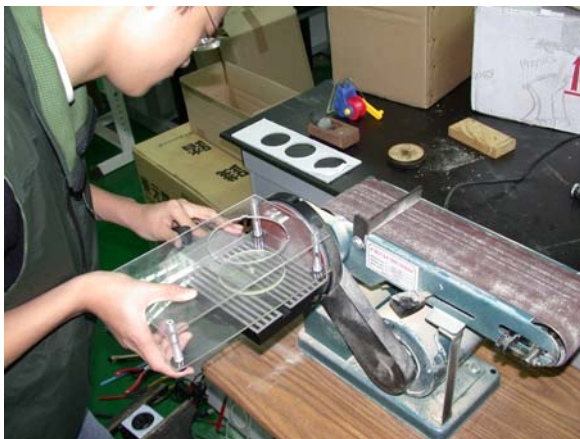
用壓克力製作箱體與底座，在工藝教室砂磨過程
