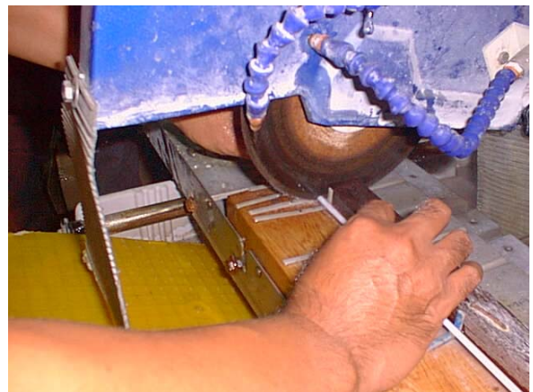
廠長示範切割毛細管專用的切刀(噴液式)
