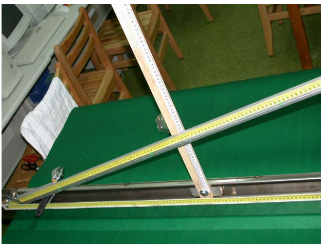
利用直角三角形邊長比可精確求得毛細管的傾斜角
