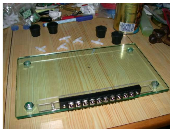
壓克力底座鎖上外接線排預備連結晶片與外電路
