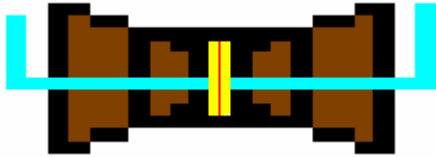
(圖三) 空心圓柱和木塞結合而成,紅色部分為空心, 淺藍色的部分為銅線。
