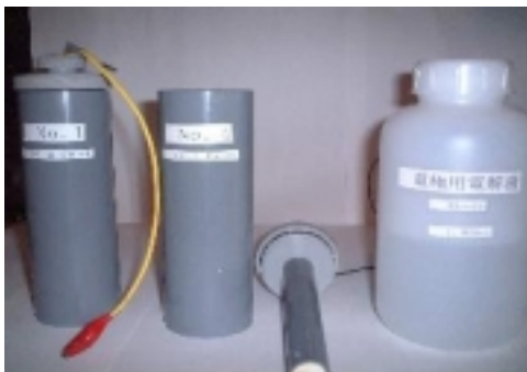
圖二 訂作電極 此為銀—氯化銀電極、電解質為硝酸銀溶液
