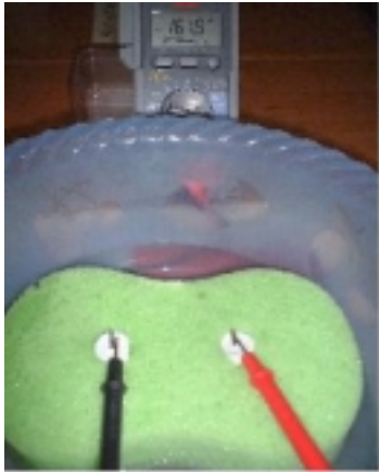
圖三 海棉內吸足水時量測的電位值
