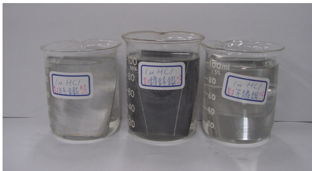
圖 13 (a) 不鏽鋼 SS304、鍍鋅鐵、純鐵浸於 1.0MHCl 3 分鐘後，顯示不鏽鋼耐腐蝕力最好，鍍鋅鐵最快反應，但內部鐵得到保護。
