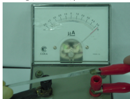
圖 4 苯胺電聚合後可以作為電池，產生電流及電壓
