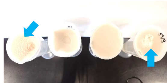
圖 5-5-2 乳製品與茶湯混合後，過濾時可在濾紙上觀察到固態物質（藍色箭頭處） （圖片來源：自行拍攝）
