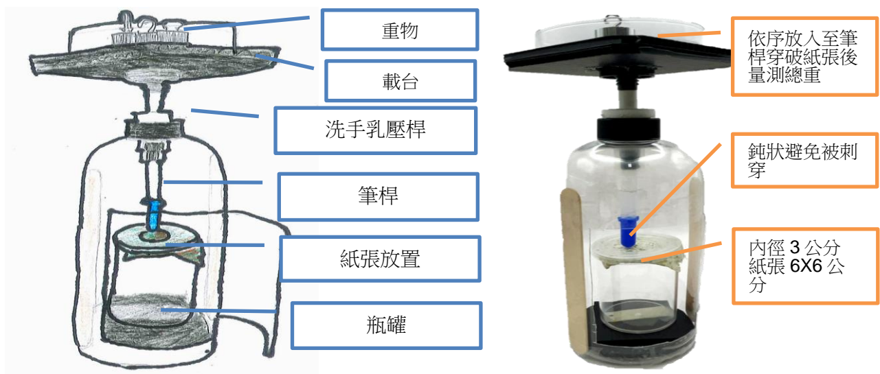
圖 3-7 抗破力檢測裝置結構
