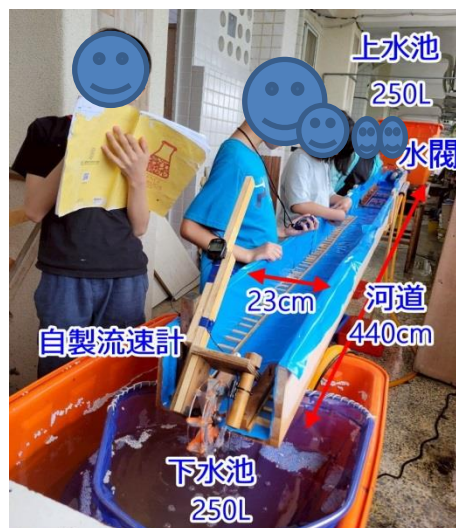
圖 4-4 自製水工模型 (本圖由指導老師拍攝)
