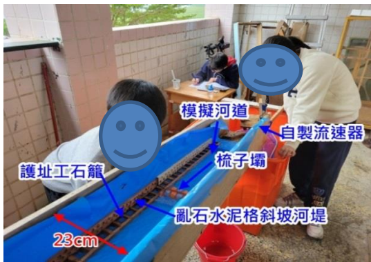
圖 4-5 自製水工模型操作 1 (本圖由指導老師拍攝)
