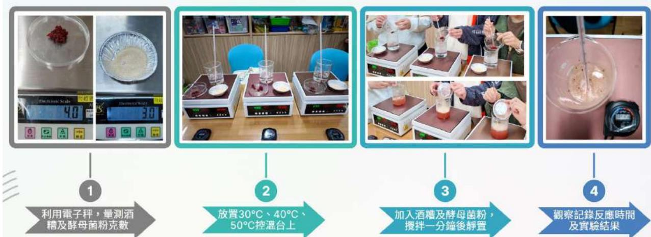
圖3-3 實驗二：不同溫度酒糟水溶液對酵母菌活性的影響實驗步驟圖 (資料來源：作者拍攝編製)
