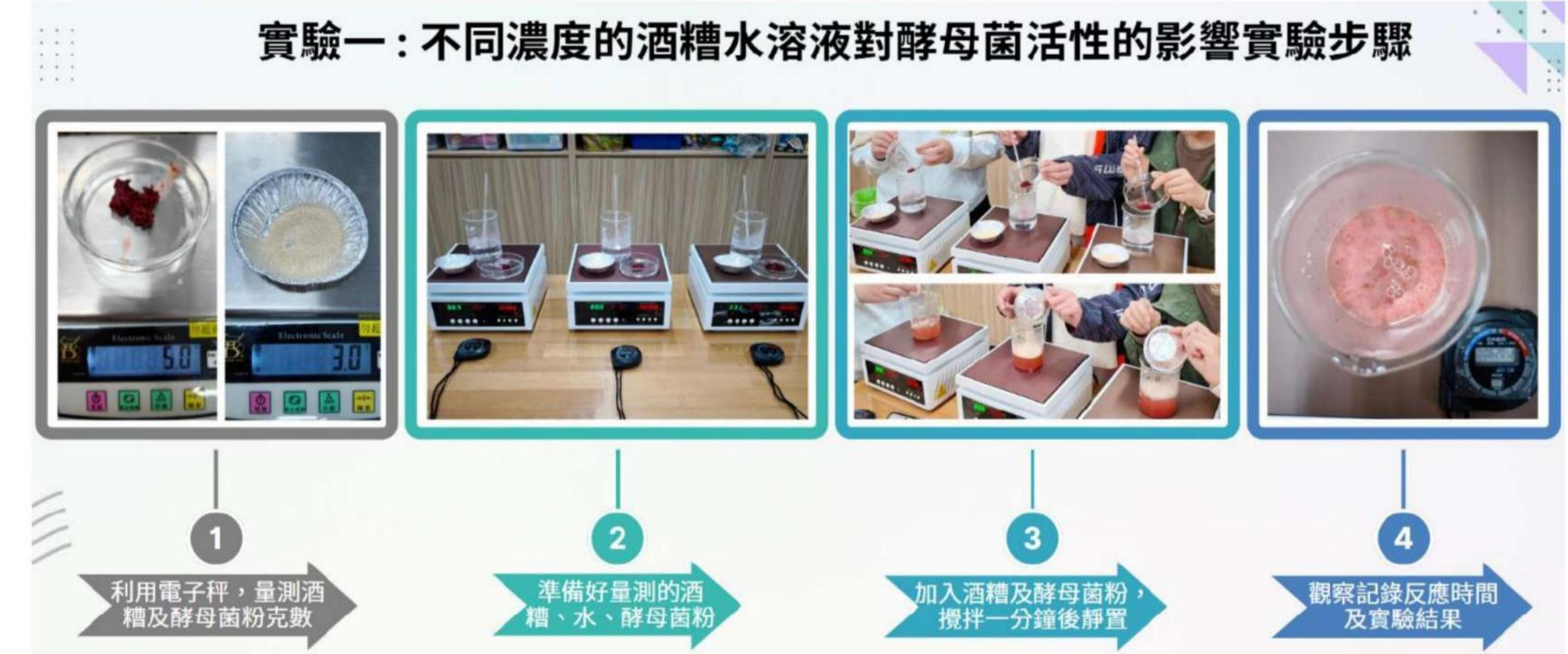
圖3-2 實驗一：不同濃度酒糟水溶液對酵母菌活性的影響實驗步驟圖(資料來源：作者自行拍攝)
