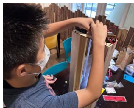
圖 14 操作示意圖 按遙控器開關電磁鐵吸住鐵釘，放開遙控器會形成斷電，鐵釘會順著軌道精準插入冰淇淋中。
