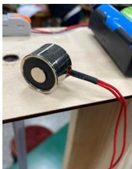
圖 12 吸盤式電磁鐵 取代傳統漆包線繞吸管的電磁鐵，改善軌道會過熱變形問題。
