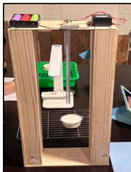
圖 13 第三代硬度測量儀器 改吸盤式電磁鐵後，將原本雷切機裁切的圓孔黏上吸管當作軌道。
