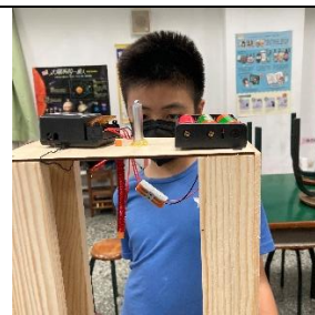
圖 10 上方加裝電磁鐵與遙控開關
