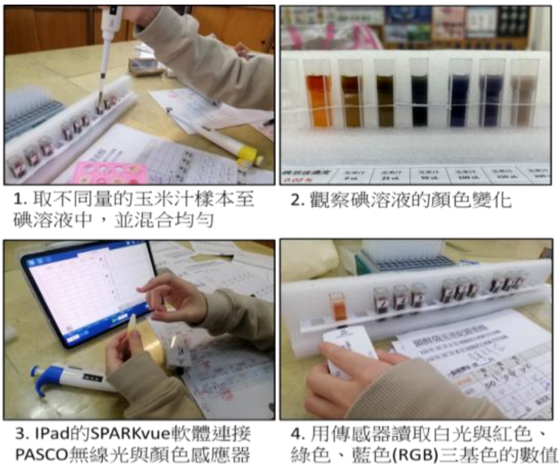
圖 10、利用無線光與顏色感應器讀取碘-澱粉反應顏色。圖片來源：研究團隊自行拍攝、繪製。
