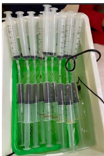
圖 3-2：自製水浴恆溫池(25℃)，0hr 甲乙丙 3 組各三管
