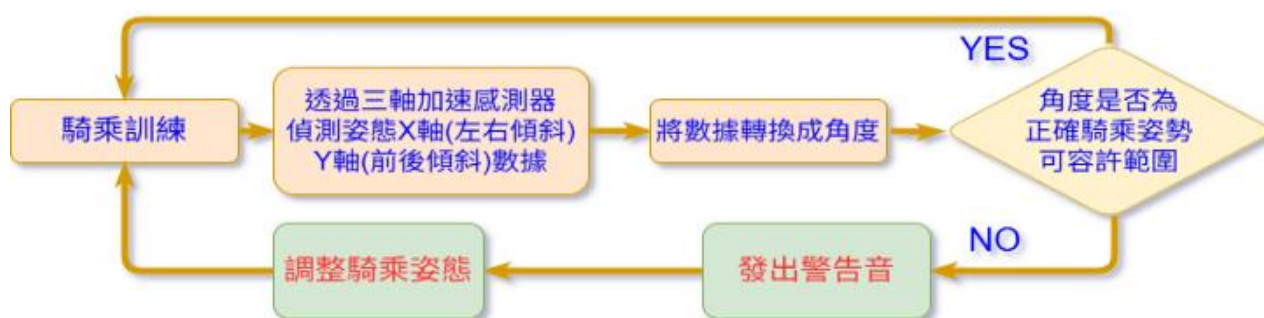
圖 3-12 如何偵測騎乘姿態及適時提醒設計邏輯圖
