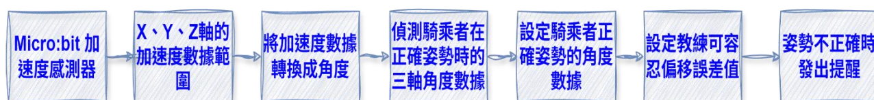
圖 3-6 三軸加速度感測器如何偵測騎乘姿態及適時提醒步驟示意圖
