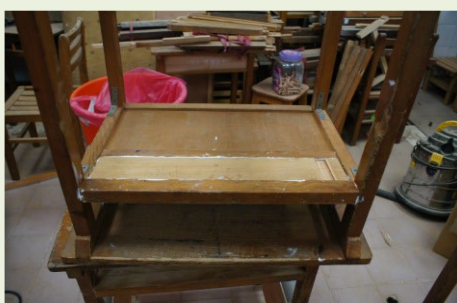
圖5-18 A2補強法增加左前4柱右前4柱橫桿
