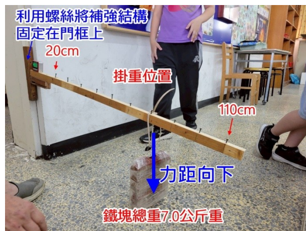
圖 5-8 破壞強度實驗設備吊重 7.0 公斤
