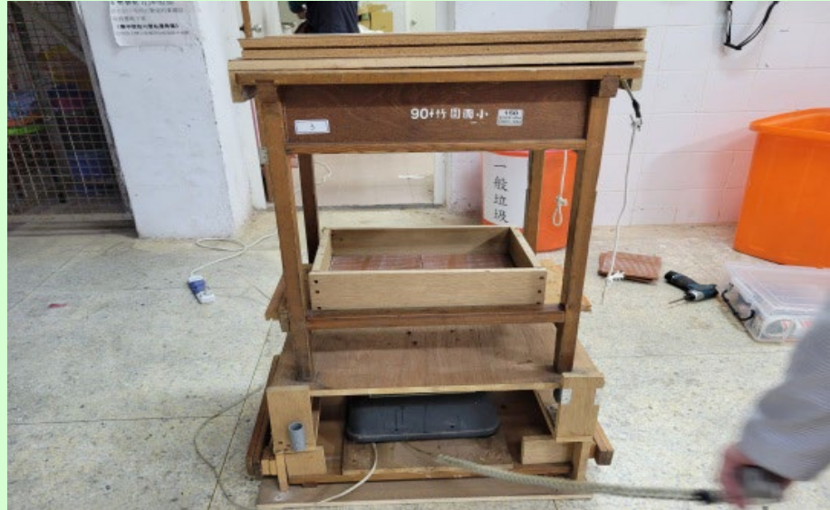
圖3-1 自製振動研究設備
