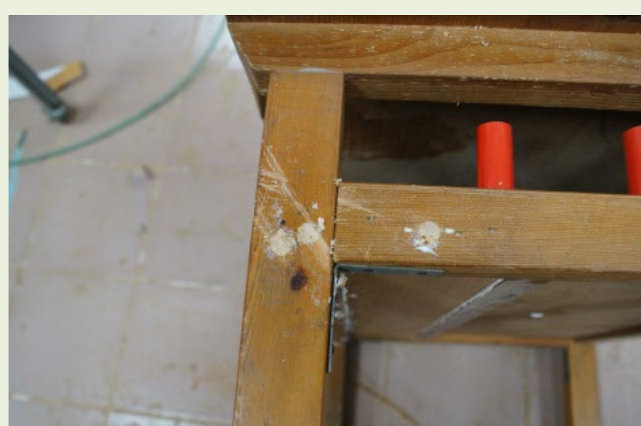
圖5-19 A2補強法打入3支直經1.0cm長度8.0cm木釘
