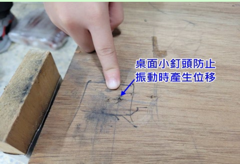
圖3-2 螺絲釘凸出約0.5cm
