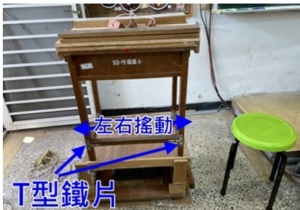
圖 5-12 T 型鐵片補強
