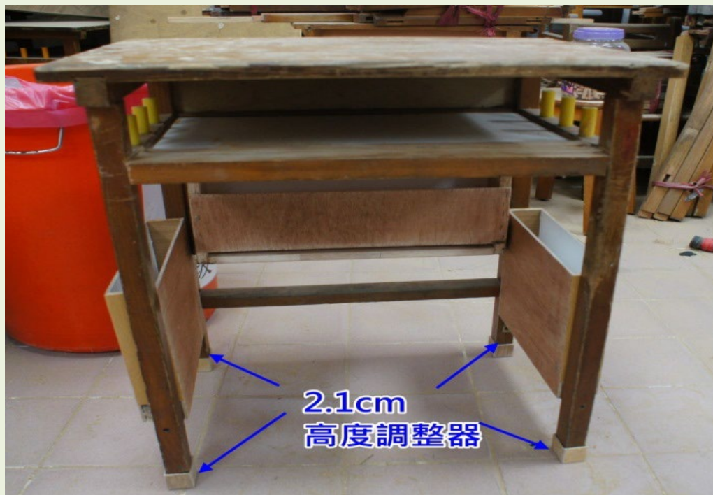
圖5-38桌子裝上高度調整器
