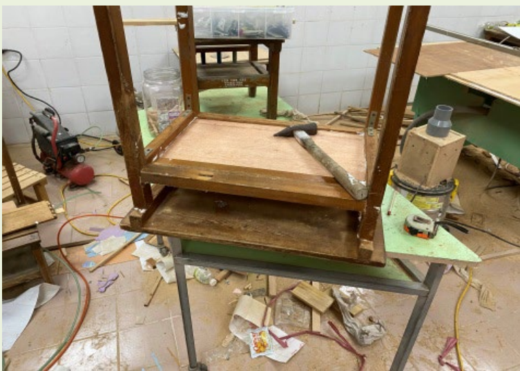
圖5-32裝設前櫃樑長度48.0寬度4.0厚度3.0cm，
