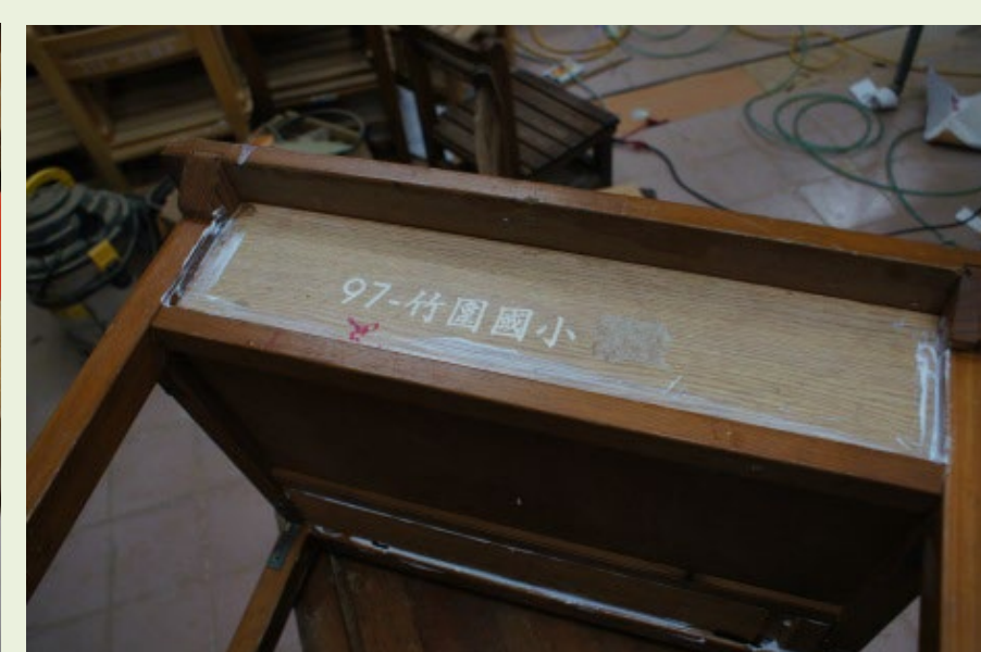
圖5-20 A3補強法增加瞬間膠與白膠補強後櫃板
