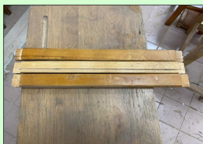
圖5-5 30年舊桌前後向樁接長4.0cm、寬1.3cm、深度為2.0cm與3.5cm。
