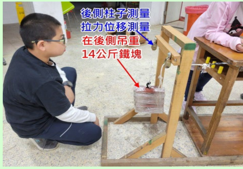
圖3-9 在後柱位置下方各吊重7公斤鐵塊2個
