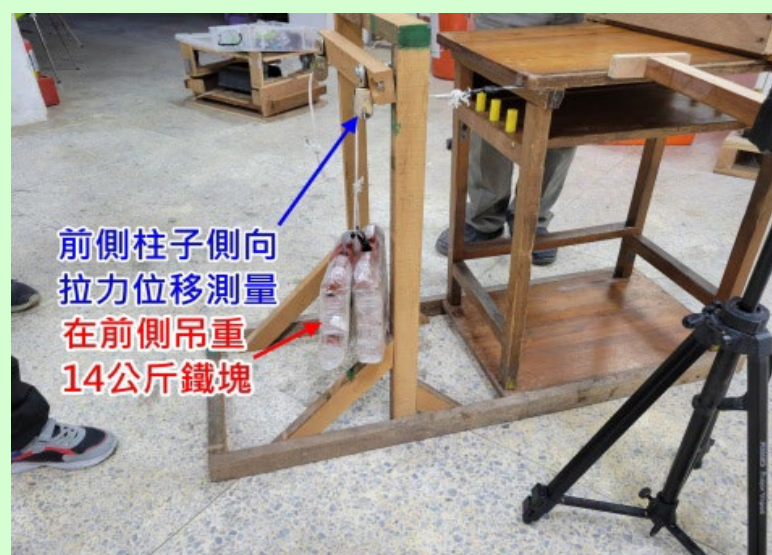
圖3-7 在前柱牽引線下方吊重7公斤鐵塊2個
