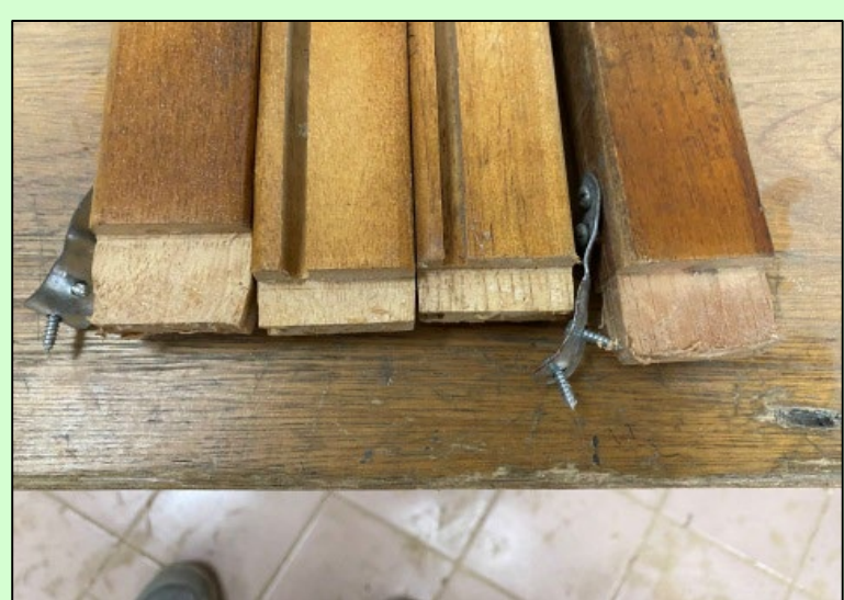
圖5-6 30年舊桌前後向樁接長4.0cm、寬1.3cm、深度為3.5cm
