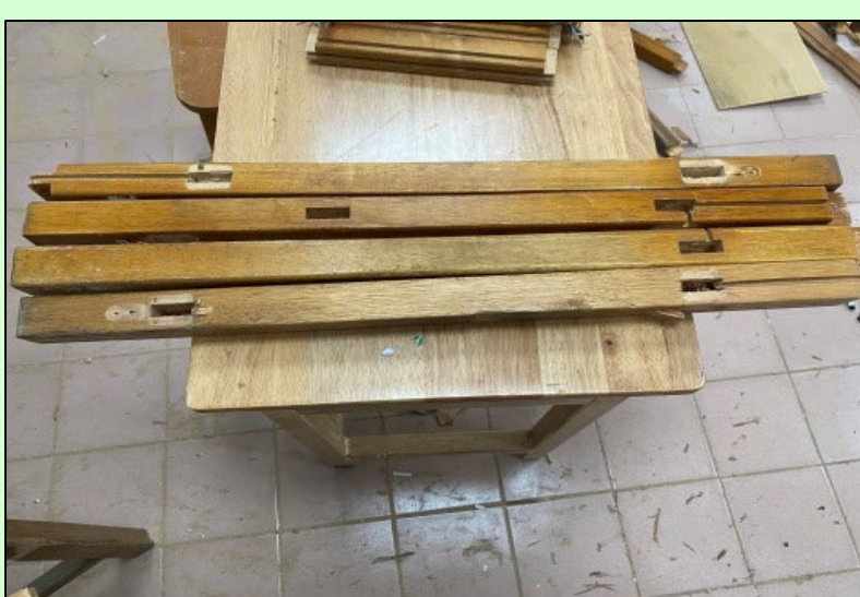
圖5-7 30年舊桌桌面樁接長4.0cm、寬1.3cm、深度為3.0cm
