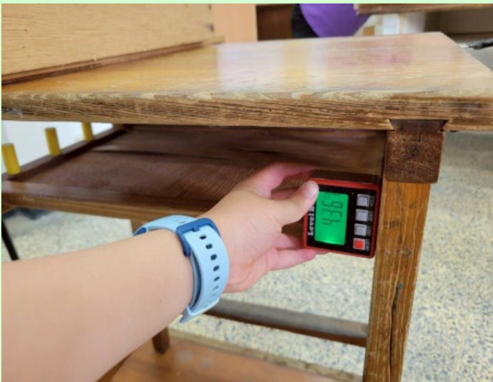
圖3-6 利用角度計測量角度線
