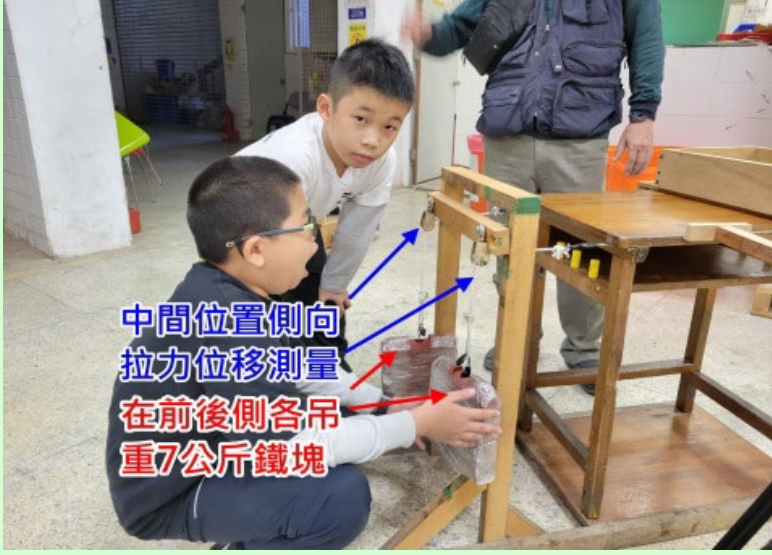
圖3-8 在前後柱位置下方各吊重7公斤鐵塊1個
