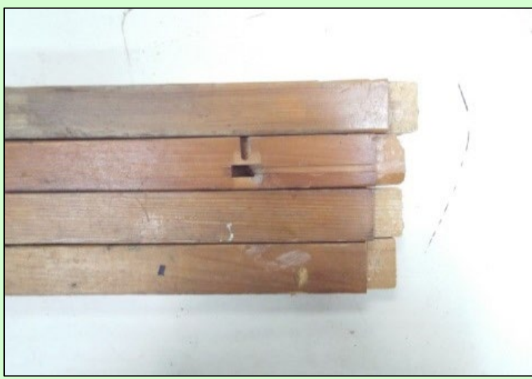
圖5-4 桌板4個接樁長4.0cm、寬1.0cm、深度為3.0m
