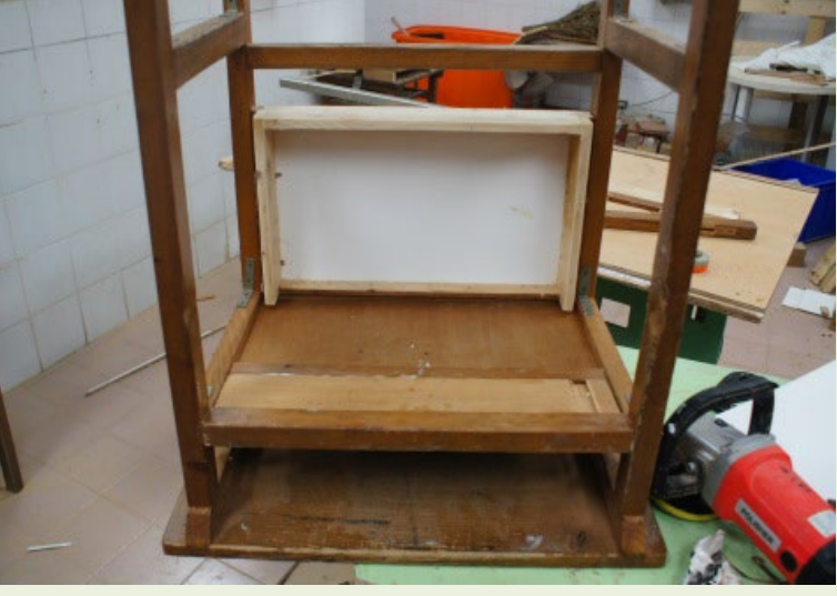
圖5-34裝上後櫃，增加放置空間強化桌子結構。
