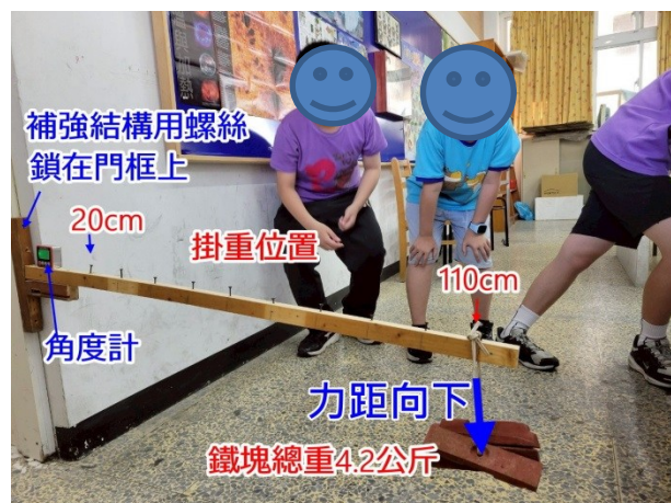
圖 5-7 結構強度測試器操作吊重 4.2 公斤
