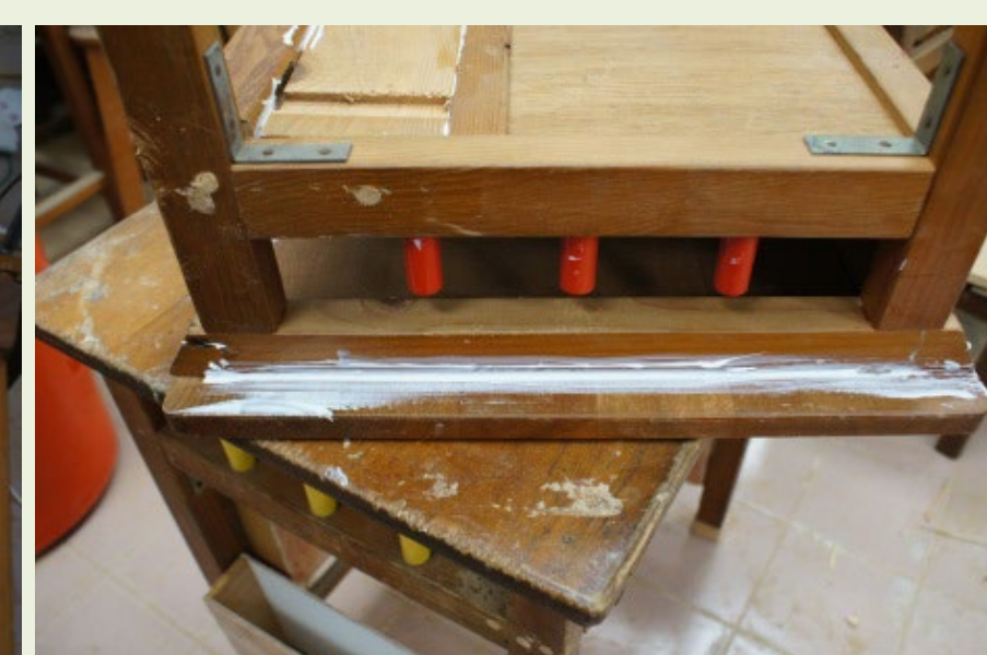
圖5-21 A3補強法增加桌面銜接燕尾樁位補強
