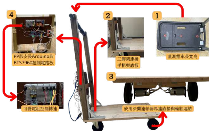
圖 4-2-5 車體製作過程圖 (作者拍攝製作)
