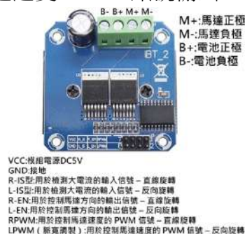
圖 4-2-1 BTS7960 腳位圖 （今華電子（n.d.））
