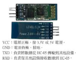
圖 4-2-3 HC-05 腳位圖（作者繪製）
