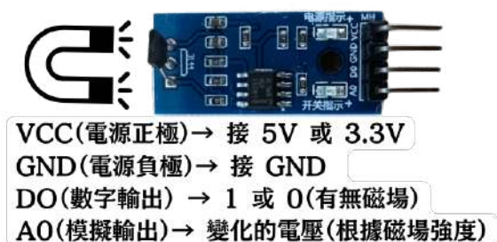
圖 4-3-1 霍爾感測器腳位圖 (作者繪製)
