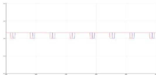
圖 4-3-8 雙霍爾馬反轉 PWM10 (擷取 Arduino 序列繪圖家)
