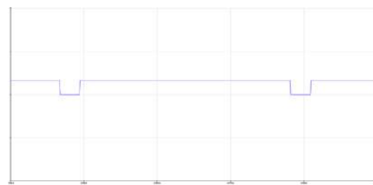
圖 4-3-4 單霍爾馬達反轉 PWM10 (擷取 Arduino 序列繪圖家)
