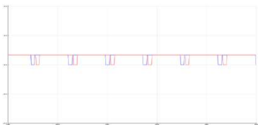
圖 4-3-7 雙霍爾馬達正轉 PWM10 (擷取 Arduino 序列繪圖家)
