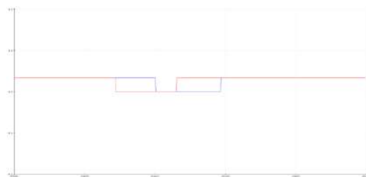
圖 4-3-10 雙霍爾加大磁鐵馬達正轉 PWM10 (擷取 Arduino 序列繪圖家)
