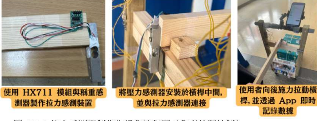
圖 4-5-5 拉力感測器製作與操作流程图 (作者拍照繪製)
