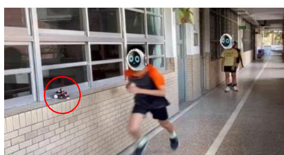
第一臺感測到有人，發廣播給第二臺，記時為 T1 第二臺感測到有人，記時為 T2，再計算 T2-T1
