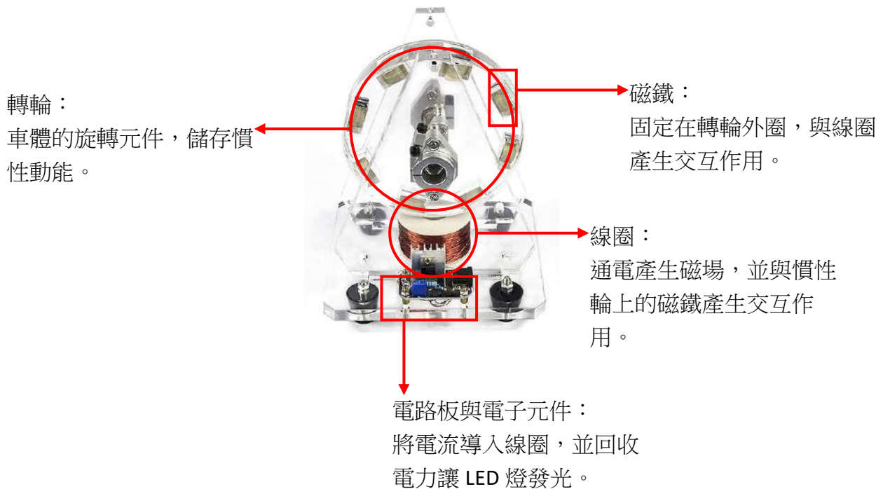
圖10. Bedini 馬達的原理(學生製作)
