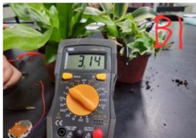
圖 35：測量添加 B1 維生素的植物串聯後的電壓數值。
