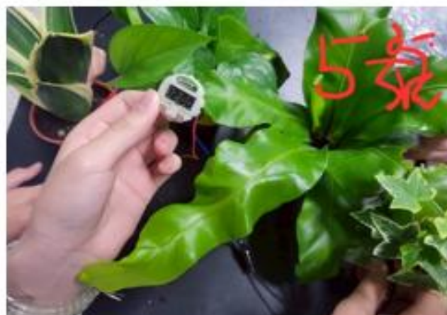
圖 34：測試添加 花寶 5 號 的植物串聯的數位小時鐘效果。
