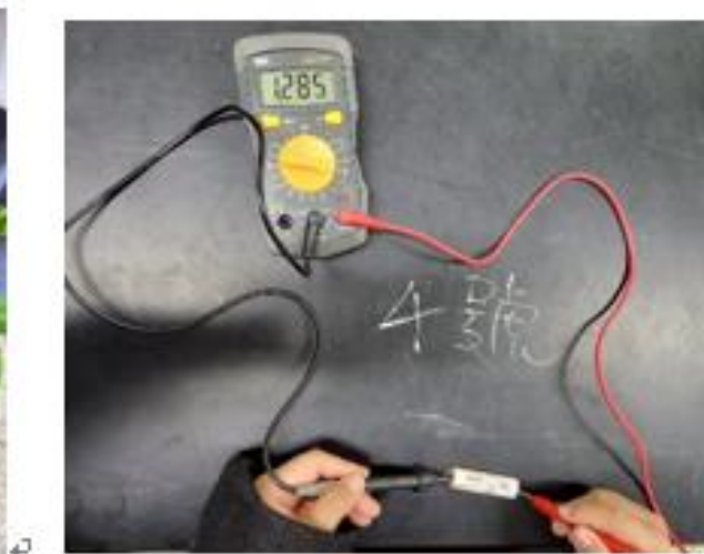
圖 38：充電後的電池電壓。
