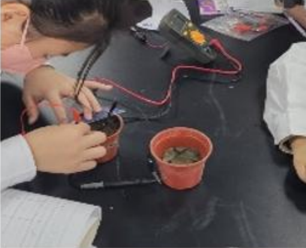
圖 18：測量土壤的電壓。
