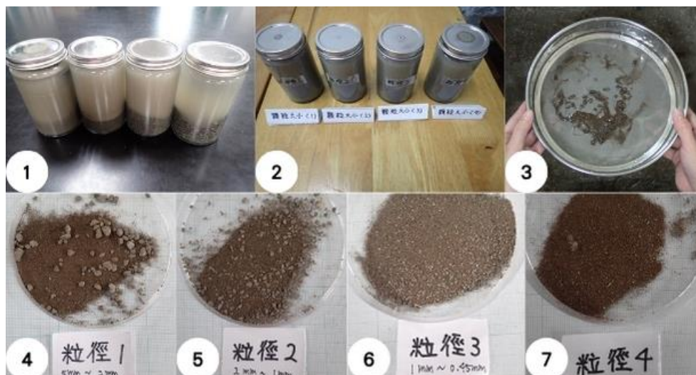
圖 4-3-2-2 不同粒徑洗選實驗的情形。1.不同顆粒大小洗選前合照。2.不同顆粒大小洗選後樣貌。3.用 0.125mm 網目篩網篩洗。4-7.不同粒徑洗選後的結果照。出處：由作者及指導老師拍攝。
