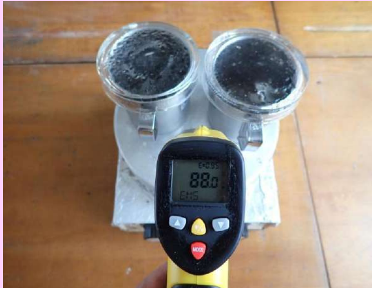
烘乾岩樣並測量加熱鐵板溫度
