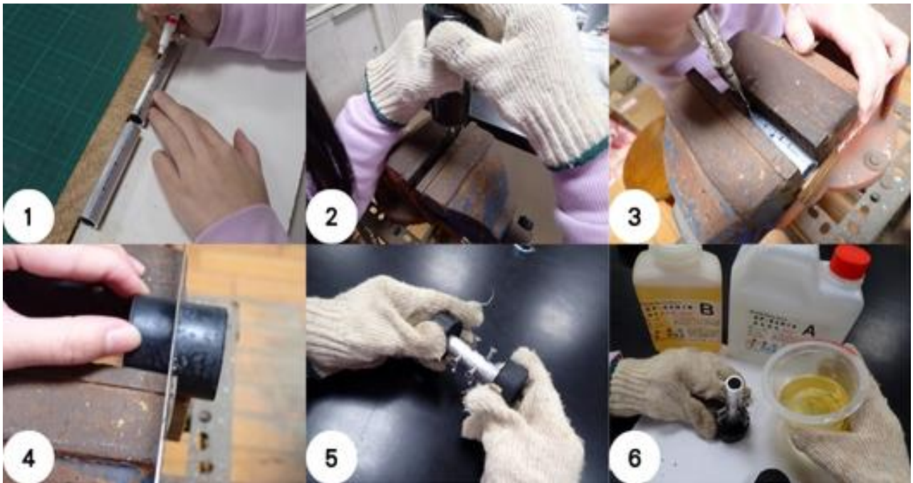
圖 3-2-3 製作製作滾筒機轉子過程。1. 標記不鏽鋼管。2. 在標記孔位處鑽洞。3. 鎖上攪拌用不鏽鋼螺絲。4. 切割黑色橡膠塞。5. 裝上橡膠塞轉輪。6. 用 AB 膠填充轉軸鋼管空隙。出處：由指導老師拍攝。
