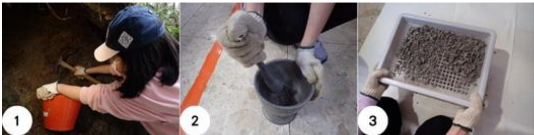
圖 3-3-1 採樣、碎化及過篩。1. 採集國寶社區大樓旁較新鮮的大寮層泥岩。2. 搗碎岩石樣本。3. 將岩石樣本過篩。出處：由指導老師拍攝。
