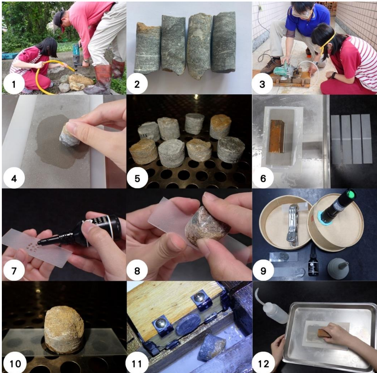
圖 3-4-1 用自製設備手工製作岩石薄片過程。1. 師生合作鑽取岩心。2. 鑽取的岩心。3. 用自製切割設備將岩心分切。4. 用金鋼砂磨片磨平要貼合的那一面。5. 烘乾岩心標本。6. 磨製毛玻璃（載玻片）。7. 上 UV 膠。8. 黏合載玻片與岩石樣本。9. 用紫外線燈固化 UV 膠。10. 用烘箱加熱再加強固化膠合。11. 將岩心標本切割成厚度約 2~3mm 的岩石切片。12. 手工磨製岩石薄片。出處：由作者、指導老師拍攝。
