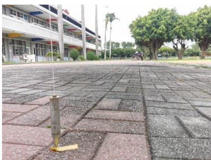
圖 3-9、棉線綁下振自三樓垂至地面
