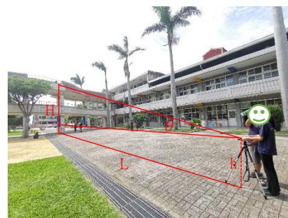
圖 3-11、光束對準標的，以手機 phyphox ® APP 測量
