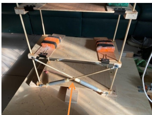
圖 5-10 阻尼器配置 X 型左右 1 樓共 4 支 (本圖由學生拍攝)
