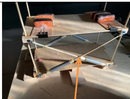
圖 5-9 配置 2 支黏滯性阻尼器 (本圖由學生拍攝)
