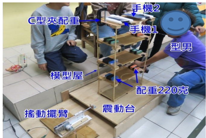
圖4-1 自製地震模擬器（模型大才好玩） （本圖由學生拍攝）
