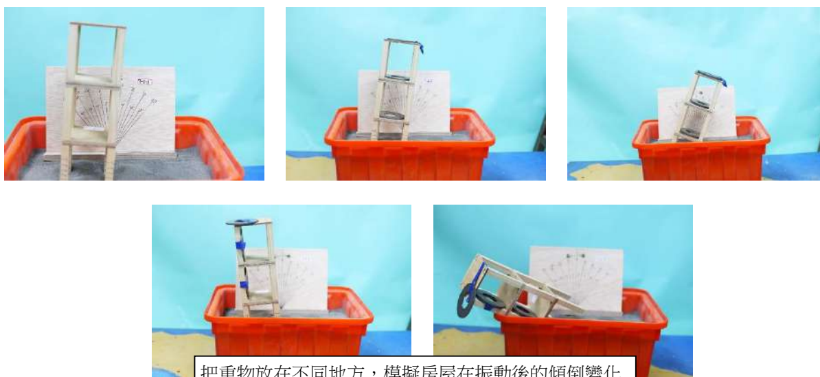
把重物放在不同地方，模擬房屋在振動後的傾倒變化
