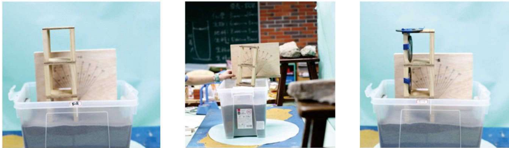
模擬房屋放置重物的位置不同，地震後的變化。
