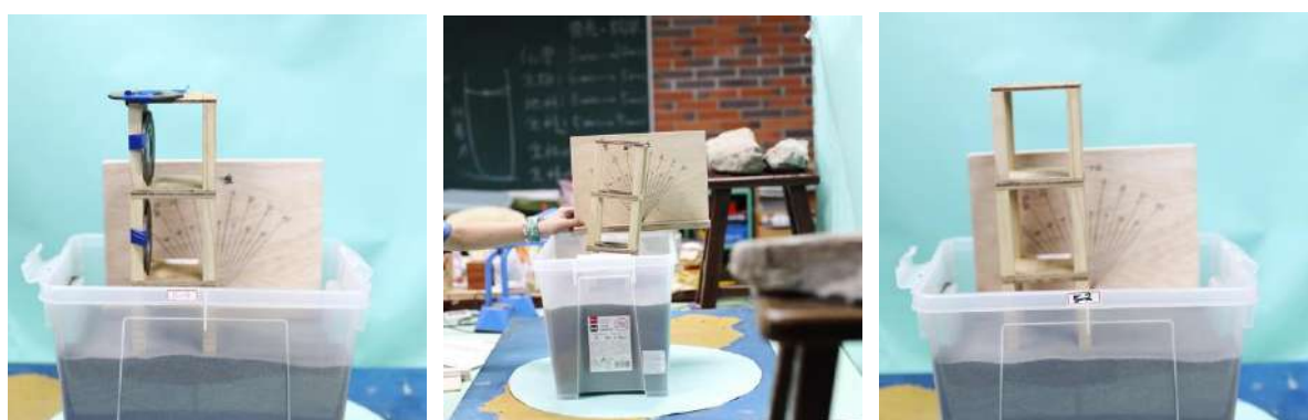
模擬房屋放置重物的位置不同，地震後的變化。
