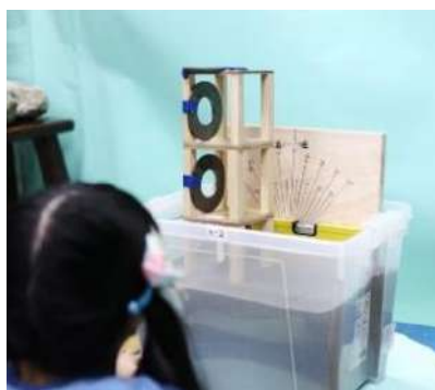
二棟不同高度的三層房屋支架，在地面上放置不同重物的變化
