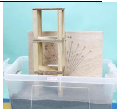
模擬地震時，泥砂的土地上房屋支架的變化
