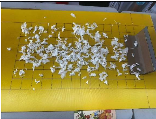
照片3.使用衛生紙碎屑做風向觀測工具
