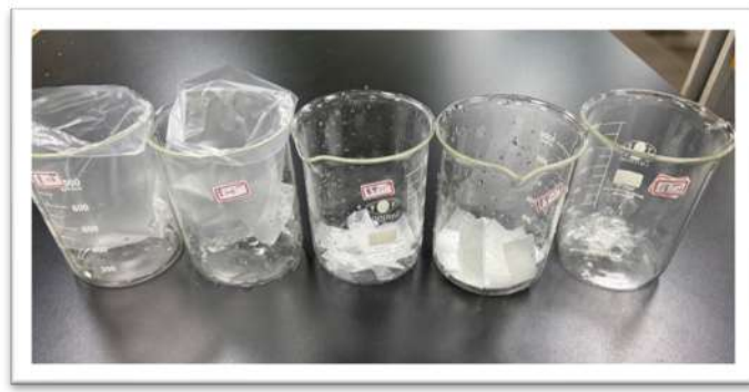
圖十八：一倍與五倍濃度 PVC 水製備(第 1 作者攝)
