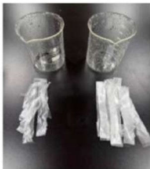
圖十八：一倍與五倍濃度 PVC 水製備(第 1 作者攝)
