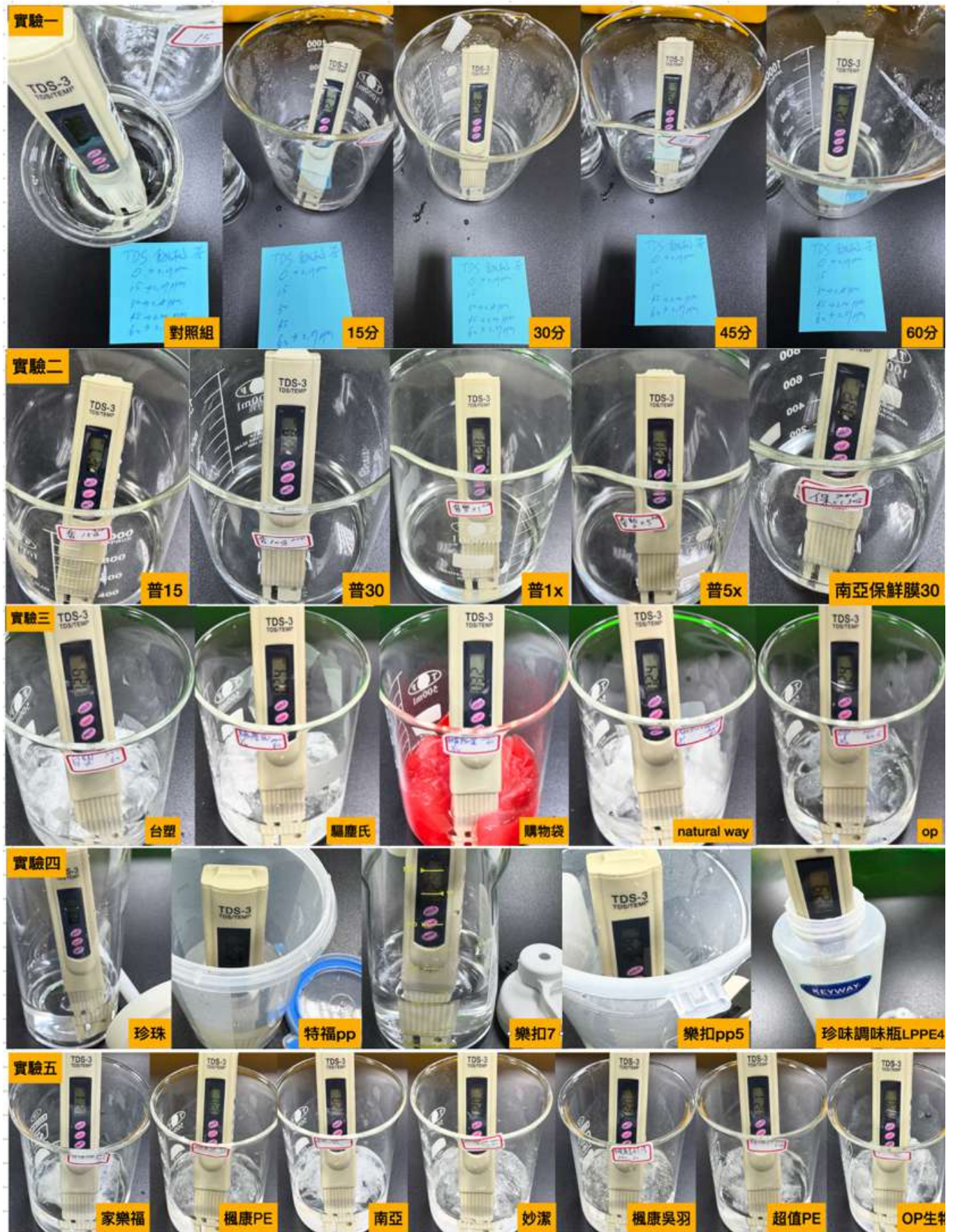
圖二十三：實驗一到實驗五進行 TDS 水質檢測(第 2 作者攝)
