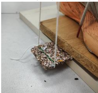
操作耐折實驗 (上圖由作者自行拍攝)
