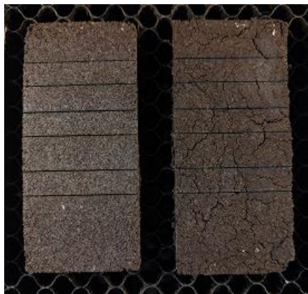
經過雷射切割的咖啡渣板材 (上圖由作者自行拍攝)
