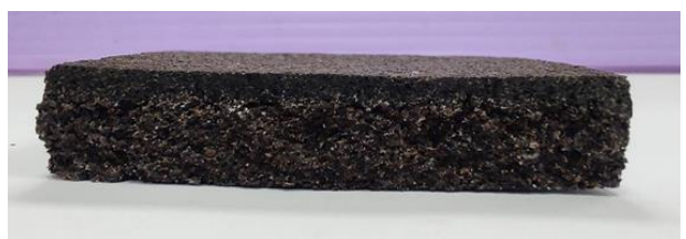
雷射切割的板材斷面 (上圖由作者自行拍攝)
