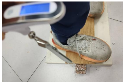
操作耐折實驗 (上圖由作者自行拍攝)
