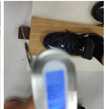
用行李秤測量耐折度 (上圖由作者自行拍攝)
