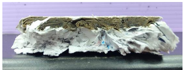
雷射切割的板材斷面 (上圖由作者自行拍攝)
