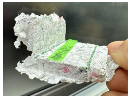
折斷的糯米糊碎紙板 (上圖由作者自行拍攝)
