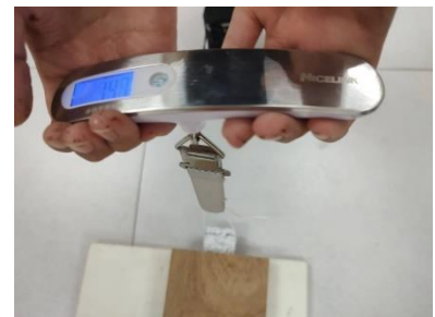
操作耐折實驗 (上圖由作者自行拍攝)
