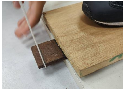
用行李秤測量耐折度-板材 4cm 處施力 (上圖由作者自行拍攝)
