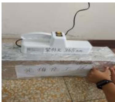
4. 放入反應容器 5 分鐘後密封紫外光照射 3 小時
