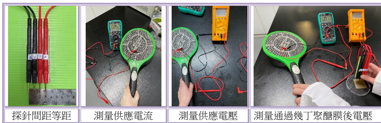
【圖 5】電阻測量過程
