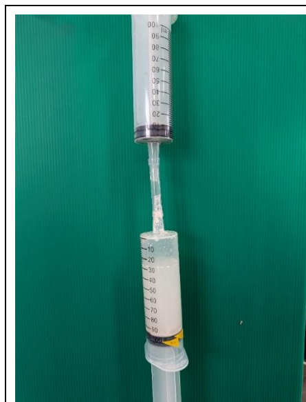
圖 9 基準對照實驗裝置（圖片/照片來源：研究團隊自拍） 註：將上方針筒裝 100mL CO 2 ，注入到下方的針筒（原裝有 200mL 純水與 3g 牡蠣殼粉）。
