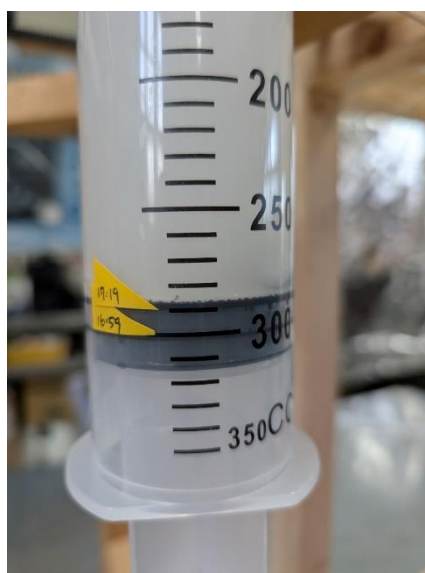
圖 10 基準對照實驗結果（圖片/照片來源：研究團隊自拍） 註：活塞至 300mL 處上升至約 290mL 處（反應量 80mL），代表在 1atm 下，牡蠣殼粉與 CO 2 與水即產生反應，使 CO 2 體積變少。
