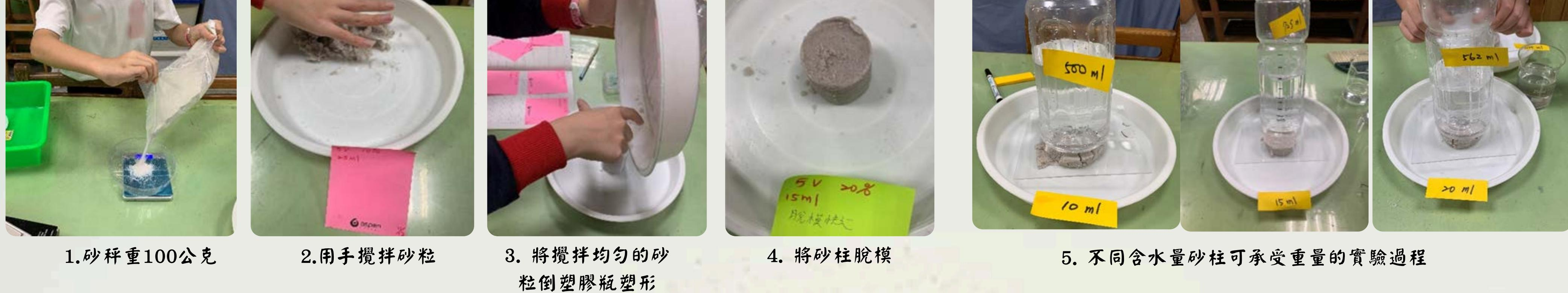
1. 砂秤重100公克 2. 用手攪拌砂粒 3. 將攪拌均勻的砂粒倒塑膠瓶塑形 4. 將砂柱脫模 5. 不同含水量砂柱可承受重量的實驗過程
