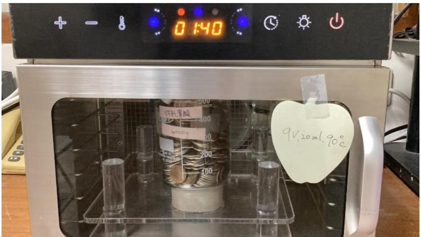
圖3、利用烘箱的熱風乾燥探討塑形砂柱是否可持續承重 (照片來源：本研究者拍攝)
