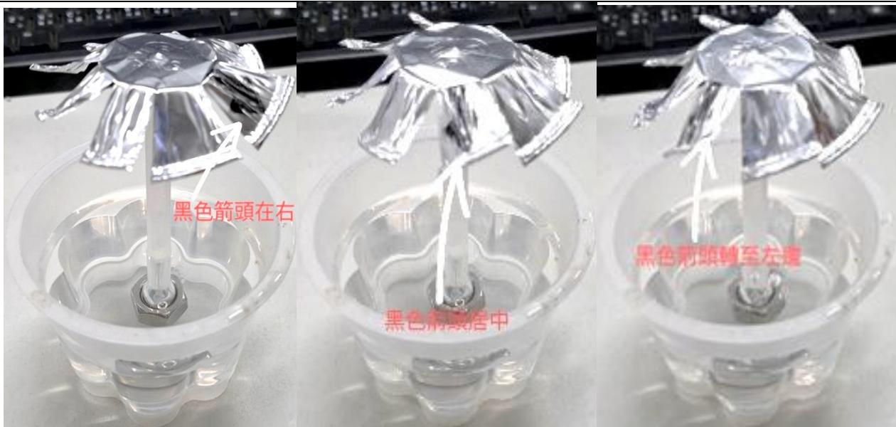
使用熱水發生順時針轉動，鋁箔葉片受到熱水蒸氣推動，轉動的連續照片。
