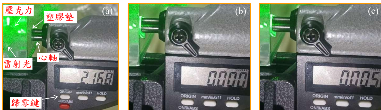
圖 33：(a)塑膠墊與壓克力距離約 2 mm 時不發光，(b)塑膠墊接觸壓克力時發亮，並將位置刻度歸零，(c)塑膠墊離開壓克力，當往外位移 5 微米(0.005 mm)時依舊發亮。(作者拍攝)
