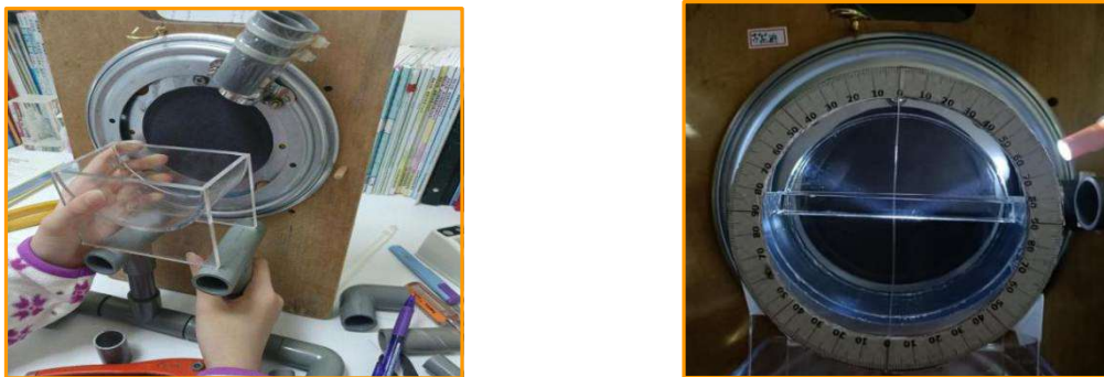
圖 17：(a)製作臨界角旋轉測量裝置，(b)校正旋轉光束與量角器的對準方式。(指導教師拍攝)
