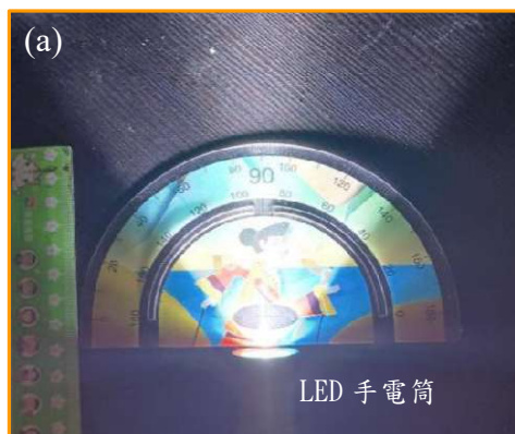
圖 16：(a)手電筒白光的發散角高達 100 度，(b)準直後發散角降至 10 度。(作者拍攝)
