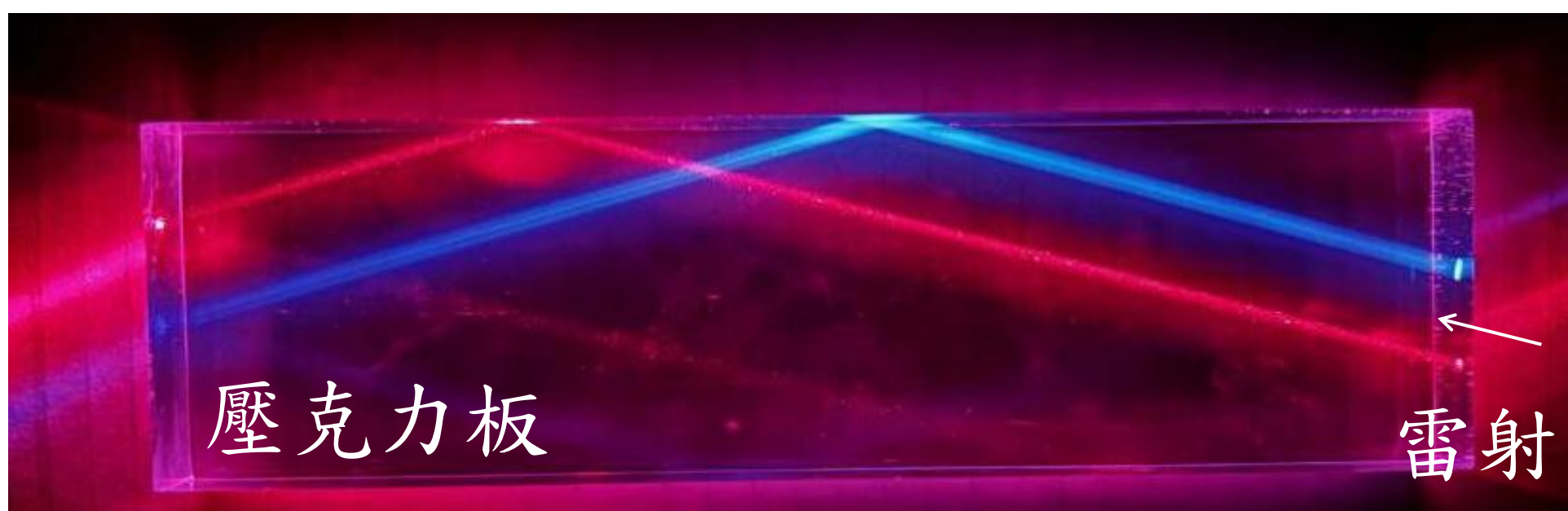
圖5. 紫光光點較紅光小(圖3)，進入壓克力後的光束卻較寬(瑞利散射)，箭頭為雷射光入射方向
