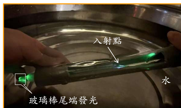
圖 31：(a)水位高過入射點，玻璃棒尾端不發光，(b)水位低過入射點，玻璃棒尾端發光。 (指導教師拍攝)
