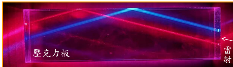
圖 12：紅紫平行光束，以傾斜角度入射壓克力板。(作者拍攝)
