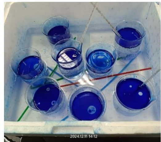
圖 3-1-10 水樣溫控系統架設圖
