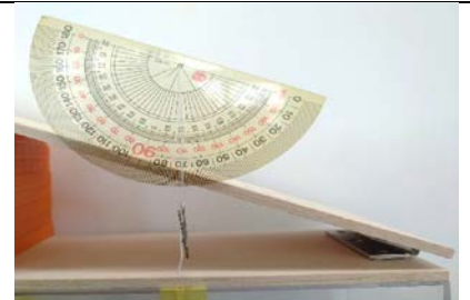
圖 7 製作斜坡角度器
